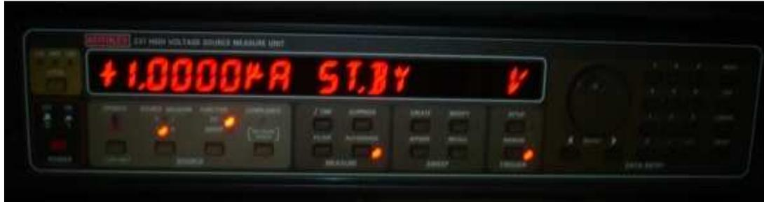
Figura 6.5 - unidade fonte medidora Keithley modelo 237
