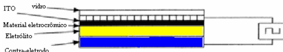
Figura 3.2 – Diagrama esquemático de um dispositivo electrocrômico [31].
