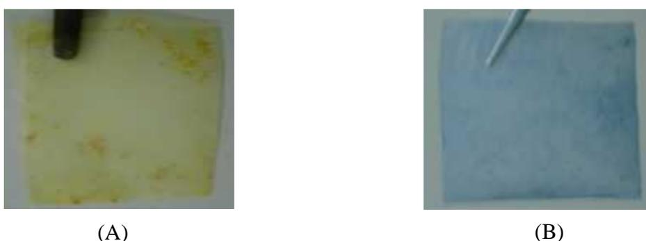
Figura 6.3 - (A) Membranas após imersão em solução de ferricianeto de potássio e (B) após exposição à solução de cloreto férrico.
