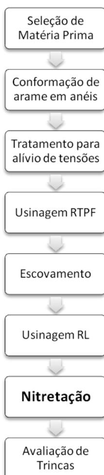
Figura 4.2: Seqüência de processamento dos anéis de pistão.
