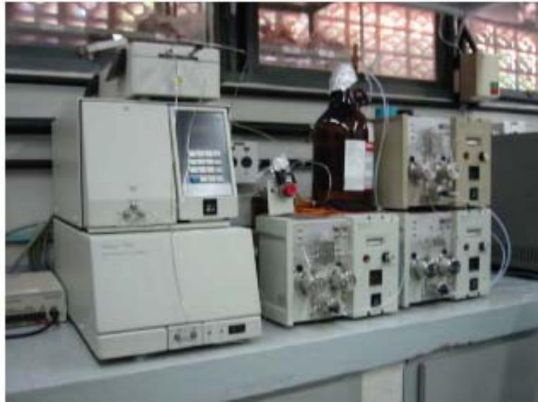
Figura 6.3: Equipamento para cromatografia de permeação em gel (GPC) Waters, modelo 510 utilizado neste trabalho. O equipamento pertence à Petroquímica União/SP.
