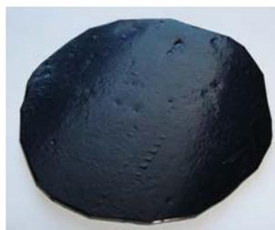
Figura 7.3 – Corpos de provas para caracterização elétrica de PEAD/PANI.DBSA e PEAD/PBP-PANI.DBSA.
