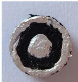
Figura 7.7 – Amostras PBP/PANI.DBSA cobertas com uma camada fina de prata para uso de anel de guarda.
