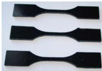
Figura 7.2 – Corpos de provas para caracterização mecânica de PEAD/PANI.DBSA e PEAD/PBP-PANI.DBSA.
