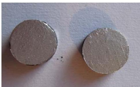
Figura 7.4 – Amostras PBP/PANI.DBSA cobertas com uma camada fina de prata para contato elétrico.
