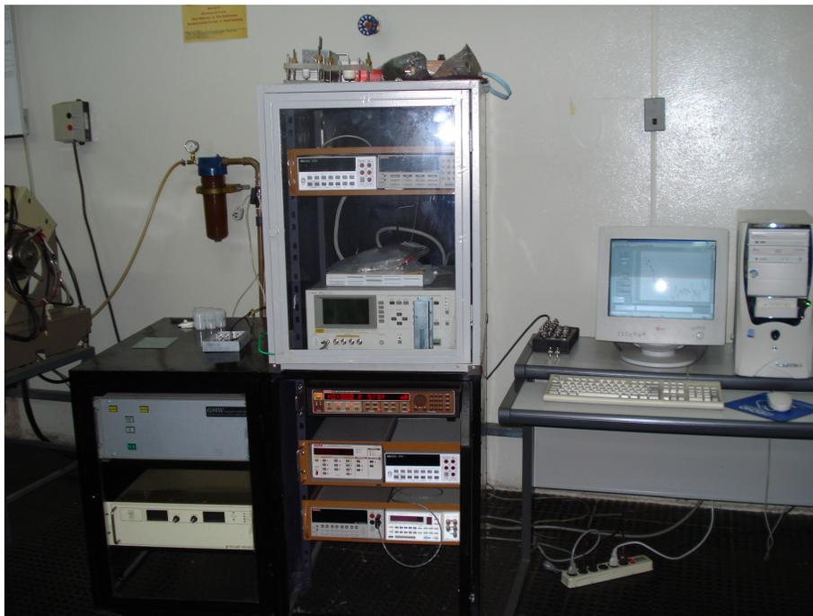
**Figura 7.4**– Unidade fonte medidora Keithley modelo 237 utilizado na caracterização do dispositivo biossensor.
