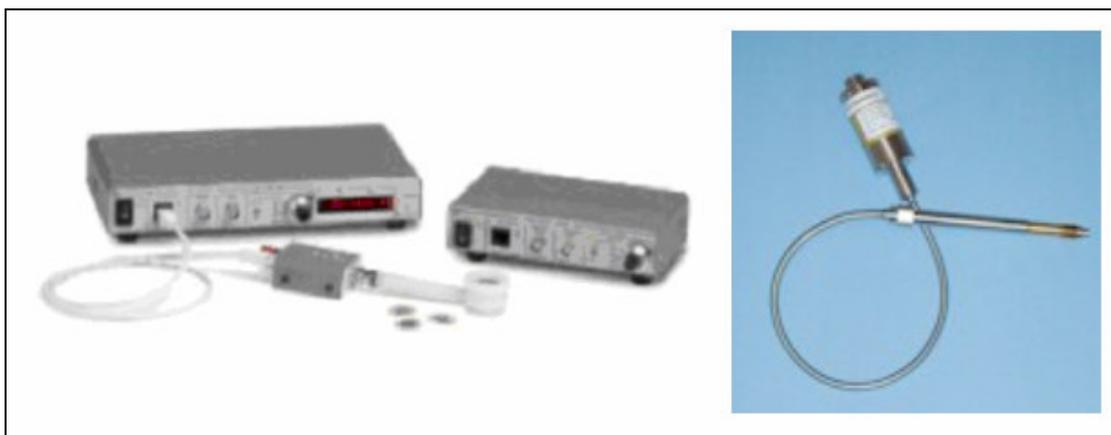
**Figura 1.10-**Microbalança de cristal de quartzo (A); Transdutor de precisão de massa (B).<sup>31-32</sup>
