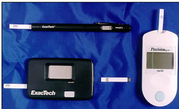
**Figura 1.5-** Biossensores amperométricos comerciais utilizados em análises clínicas.<sup>5</sup>
