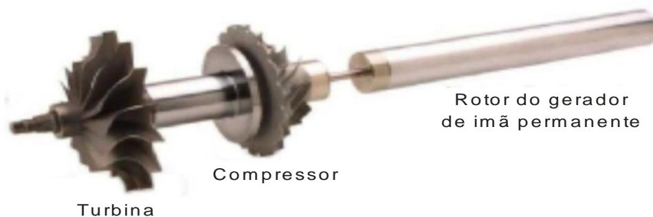
Figura 11 – Eixo de uma microturbina Capstone de 30 kW (Capstone Turbine Corporation).
