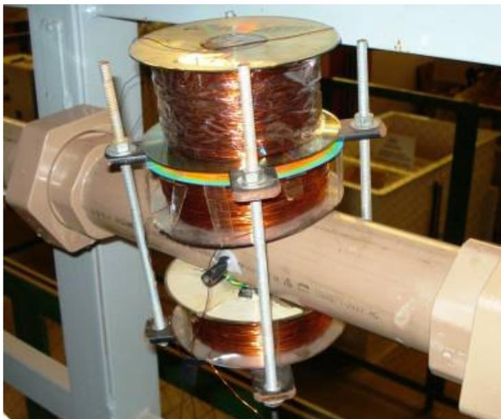
Figura 78 – Bobina de interferência colocada sobre o protótipo
