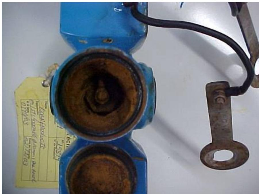
Figura 6 – Medidor eletromagnético com defeito devido a especificação incorreta (corrosão dos eletrodos)
