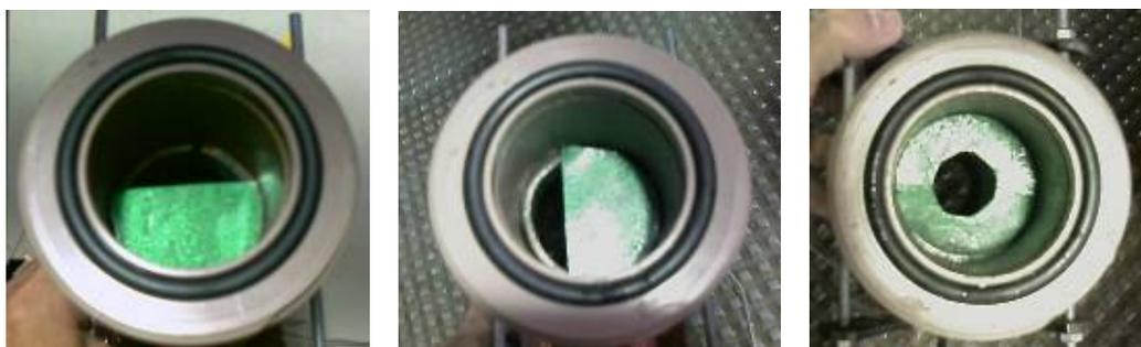
Figura 67 – Diferentes configurações de obstáculos ensaiadas
