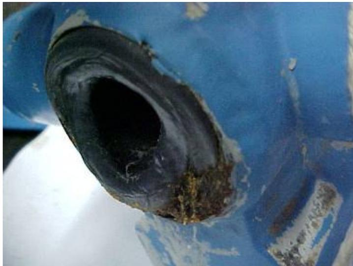
Figura 4 – Medidor eletromagnético com defeito devido a instalação incorreta
