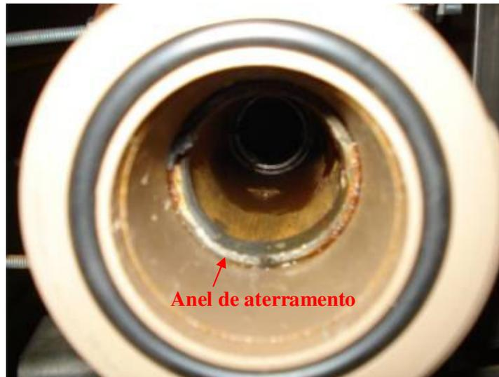
Figura 34 – Detalhe de anel de aterramento
