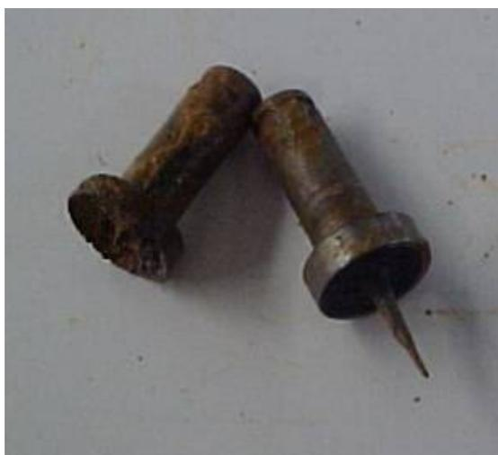
Figura 7 – Eletrodos corroídos
