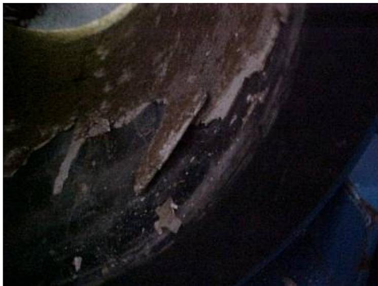
Figura 5 – Medidor eletromagnético com defeito devido a instalação incorreta (corrosão do material de revestimento interno do tubo)
