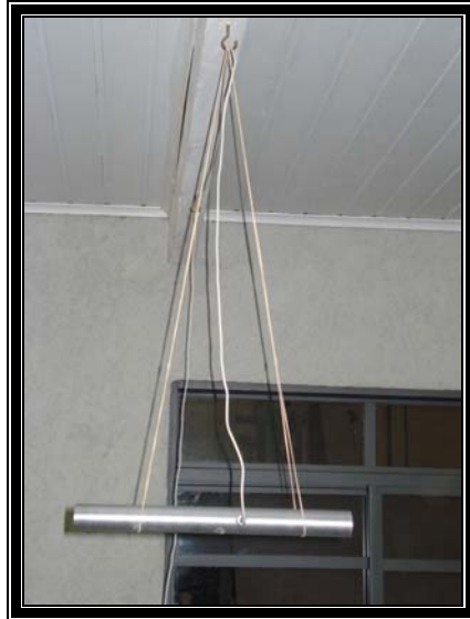
Foto 5.2 – Viga uniforme de alumínio: \phi 20,0024 \text{ mm} .
