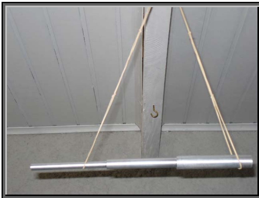
Foto 5.5 – Viga escalonada de alumínio: 1/3 do comprimento \phi 9,9408 \text{ mm} , 1/3 do comprimento \phi 14,9764 \text{ mm} e 1/3 do comprimento \phi 20,0084 \text{ mm} .
