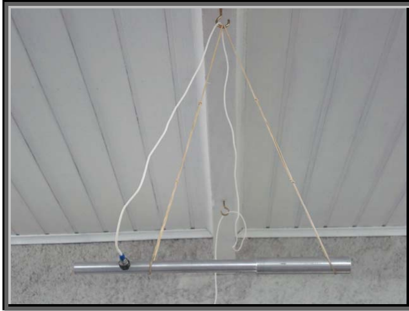
Foto 5.4 – Viga escalonada de alumínio: 2/3 do comprimento \phi 14,9672 \text{ mm} e 1/3 do comprimento \phi 20,0068 \text{ mm} .
