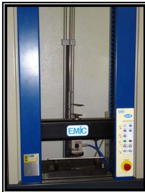
Foto B.4 – Vista frontal da máquina para ensaio de flexão.
