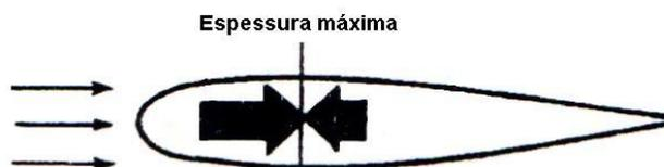
Figura 2.16 – Representação do arrasto de pressão em um aerofólio. Figura adaptada de Andrade (1999).
