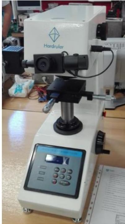
Figura 15 – Micro durômetro HVS-1000 da marca Hardruler.
