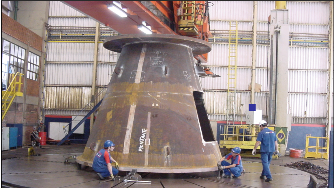
Figura: 2.1- Preparação (fixação, centragem, nivelamento) de peça na placa de um torno vertical.
