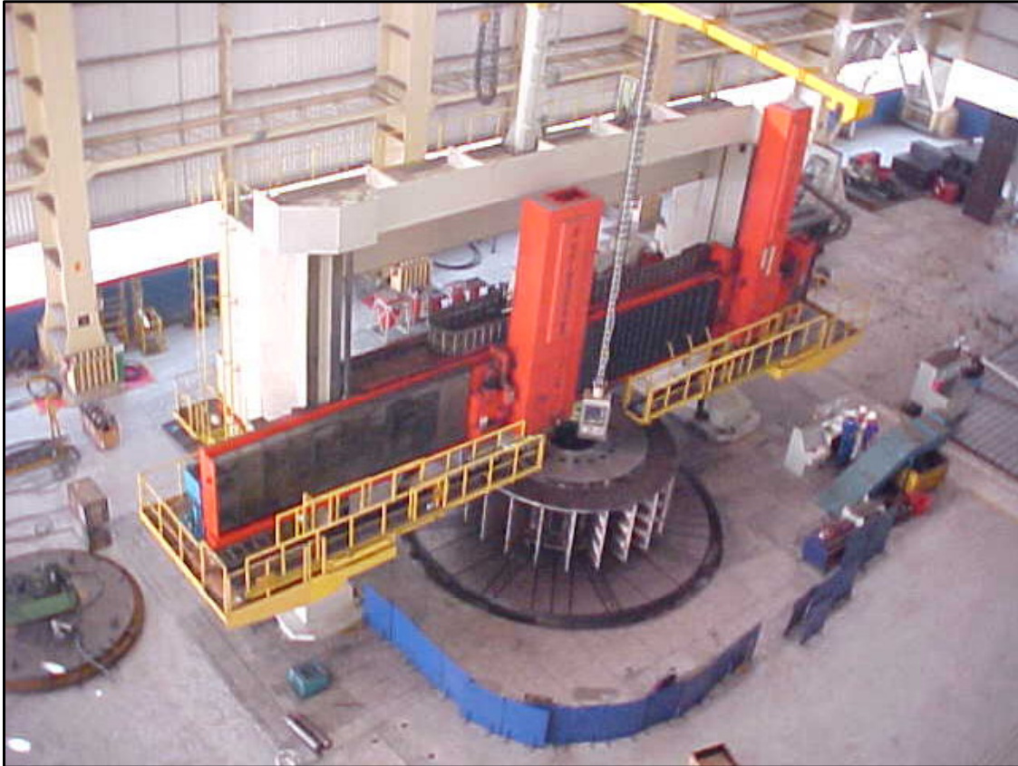
Figura 2.2: Processo de usinagem em um torno vertical.
