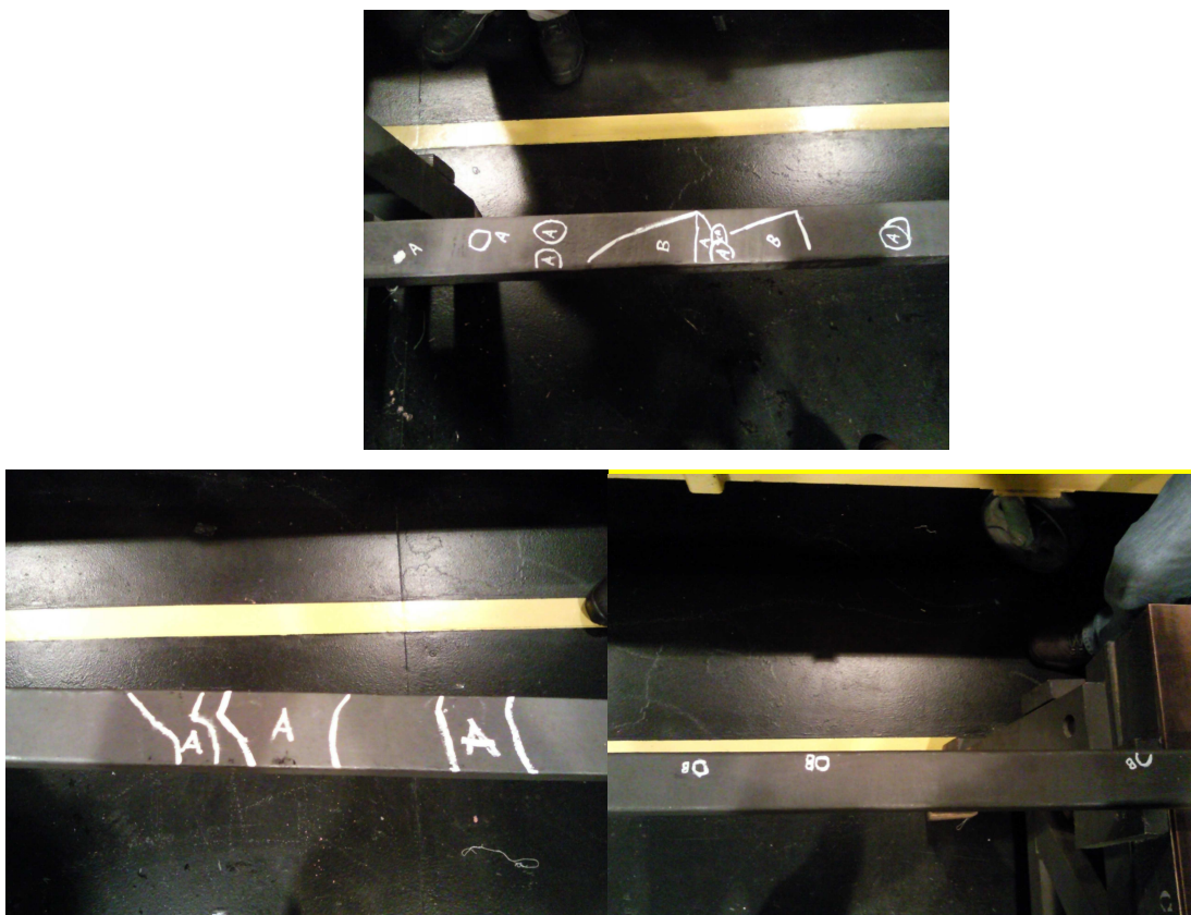
Figura 20 – Classificação das regiões delaminadas [49].
