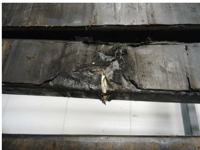
Figura 49 – Barra nº 4419 perfurada por ensaio de tensão aplicada.
