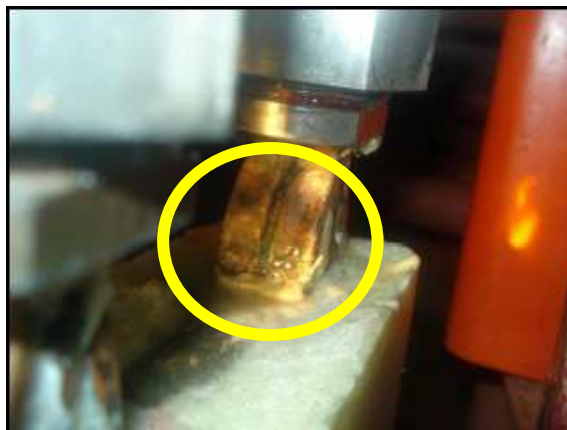
Figura 17 - Perda de água no condutor oco.
