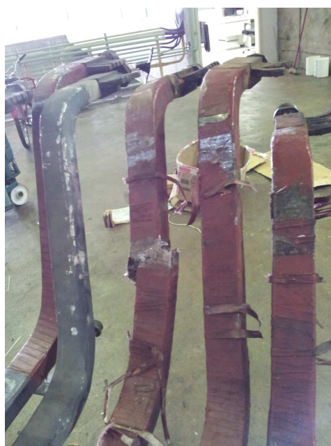
Figura 43 –Cabeça de Bobina Siemens Retirada de um Enrolamento após 19 anos de Operação.
