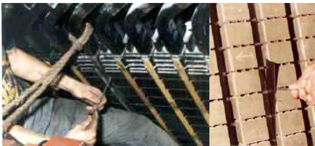
Figura 39 Detalhe de como o calço lateral é retirado com auxílio do ganchinho
