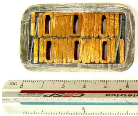
Figura 35 - Seção da barra estatórica [46].
