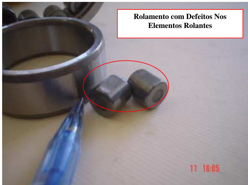
Figura 5.27 – Rolamento com defeito nos elementos rolantes – classe K4
