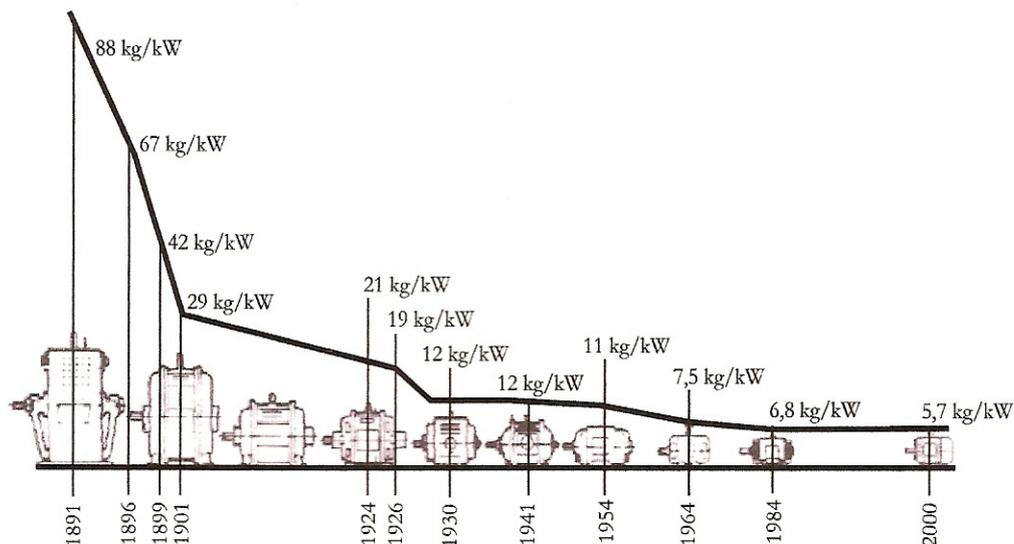
**Figura 2.4 - Evolução dos motores elétricos**
