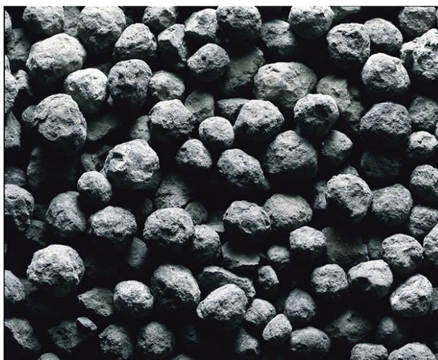
Figura 4.4 – Nódulos de clínquer produzidos por forno rotativo (CO, 2006).
