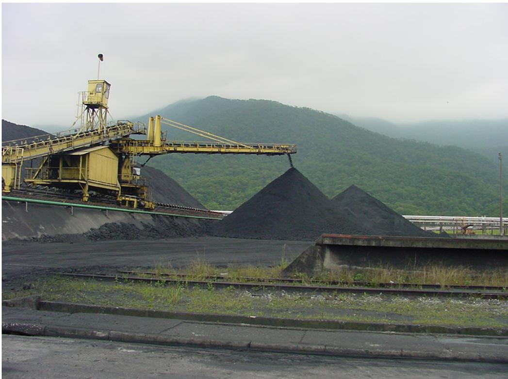
Figura 3.4 – Armazenamento de coque verde de petróleo.
