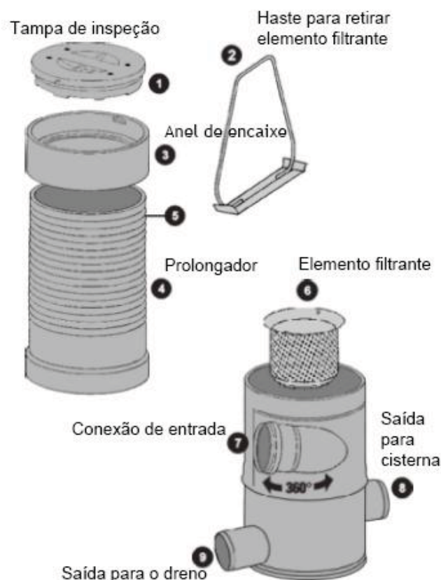
Fonte: Catálogo técnico da ( AQUASTOCK, 2007) Figura 16 – Filtro tipo Vortex.
