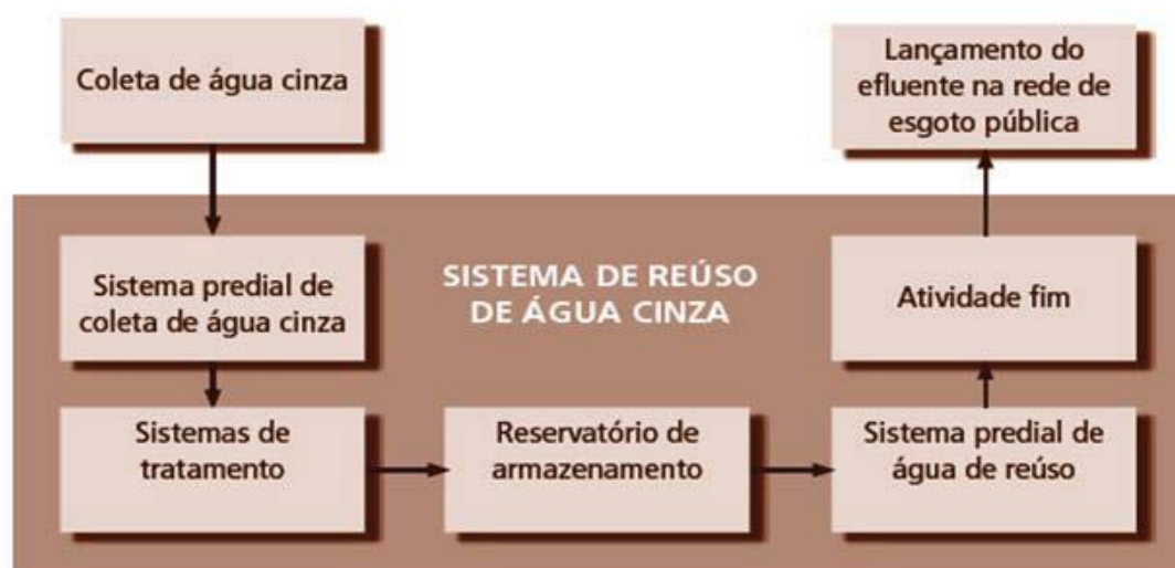
Fonte: Manual do Sinduscon (2006) Figura 12 – Sistema de reúso de águas cinzas.
