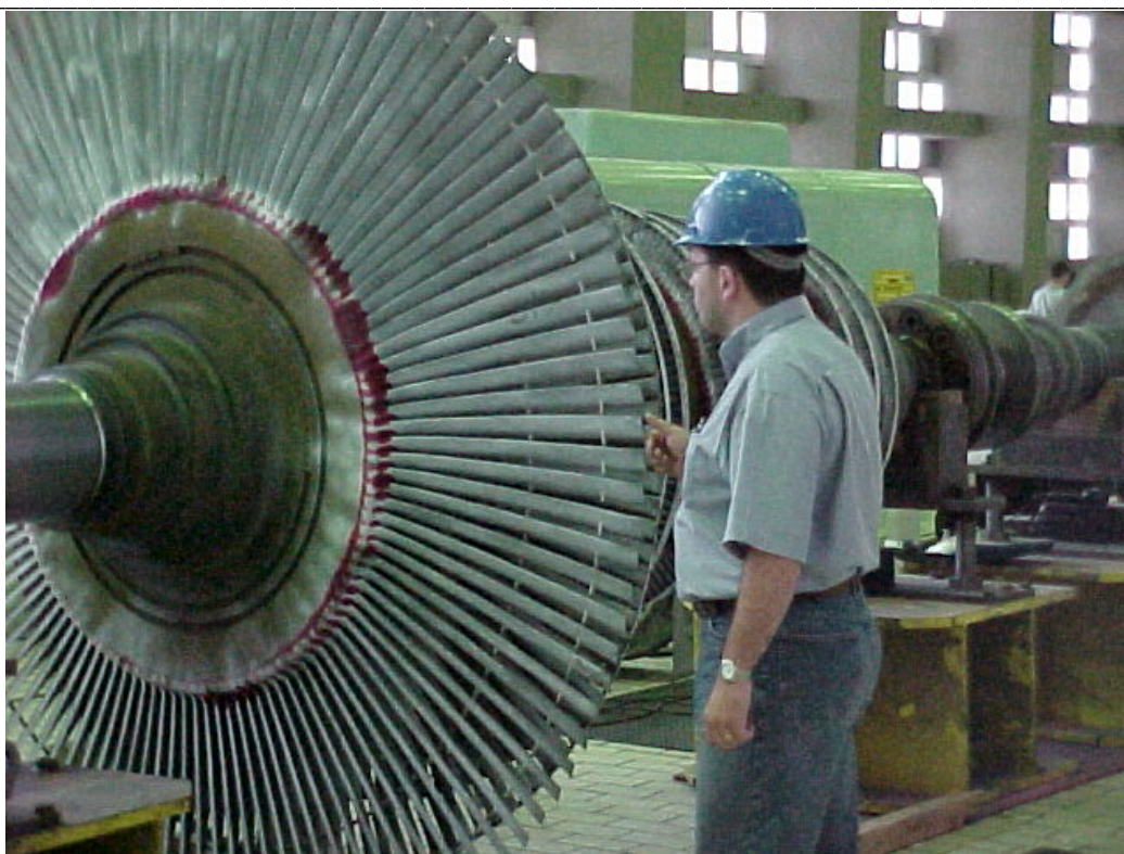
Figura 3.49: Fotografia do rotor da turbina a vapor durante o período de manutenção geral da unidade 4.
