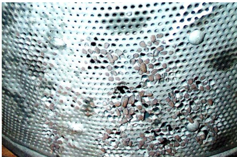
Figura 2.2: Retentor de escória (restos de soldas nas tubulações de vapor) (BEEBE, 2005).
