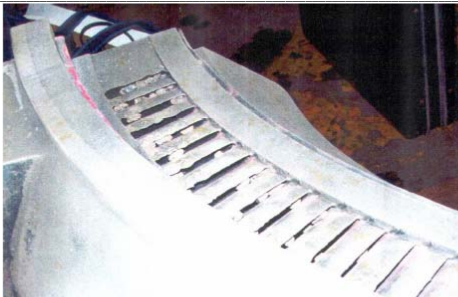
Figura 2.5: Exemplo de danos internos (incrustações) por partículas sólidas (fonte: STAGGERS ET AL, 1987).
