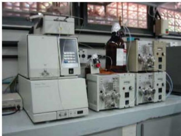
**Figura 6.5** – Equipamento para cromatografia de permeação em gel (GPC) Waters, modelo 510 utilizado neste trabalho. O equipamento pertence à Petroquímica União/ SP.
