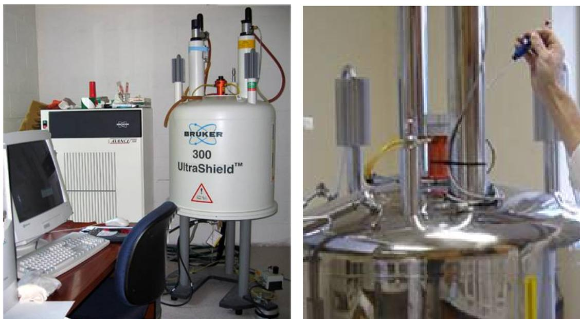
**Figura 6.4** – Equipamento de RMN Bruker 300 MHz (A) e Bruker 500 MHz (B) do ICTP/CSIC. Nota-se em (B) a introdução da amostra no equipamento de RMN.
