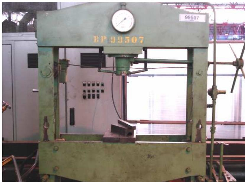
**Figura 6.3** - Prensa hidráulica manual
