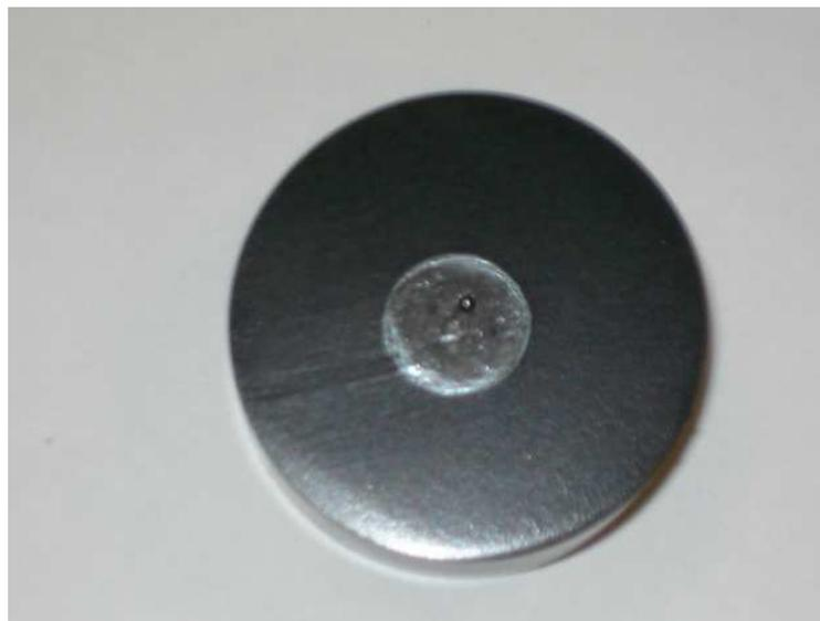
**Figura 5.6** - Corpo de prova embutido em baquelite
