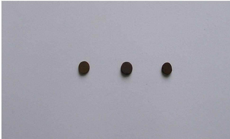
**Figura 5.4** – Amostras prensadas do material que aderiu ao imã permanente
