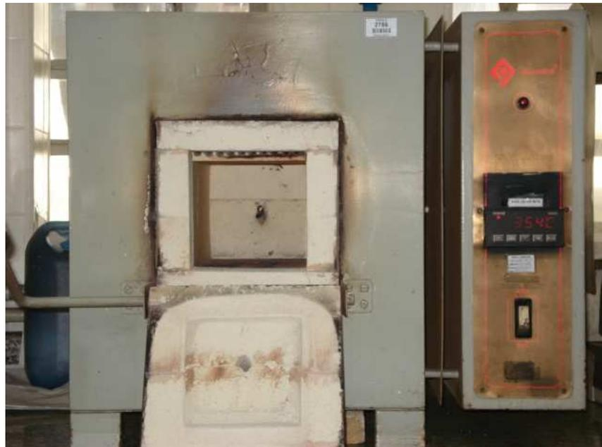
**Figura 6.5** – Forno elétrico tipo mufla marca Quimis.
