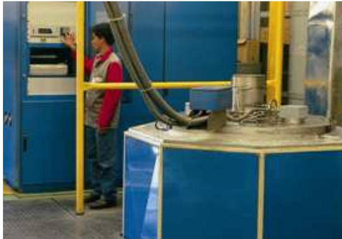
**Figura 4.17** - Forno elétrico tipo poço com detalhe da tubulação para a injeção de nitrogênio [10]
