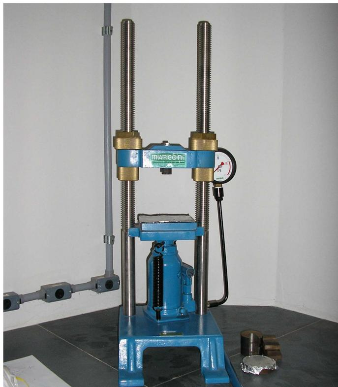
**Figura 5.3** - Prensa hidráulica manual (Marconi) Laboratório de Materiais Cerâmicos ICE/UNIFEI
