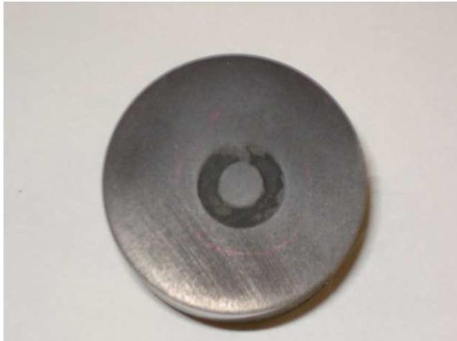
**Figura 6.7** - Bucha sinterizada embutida em baquelite
