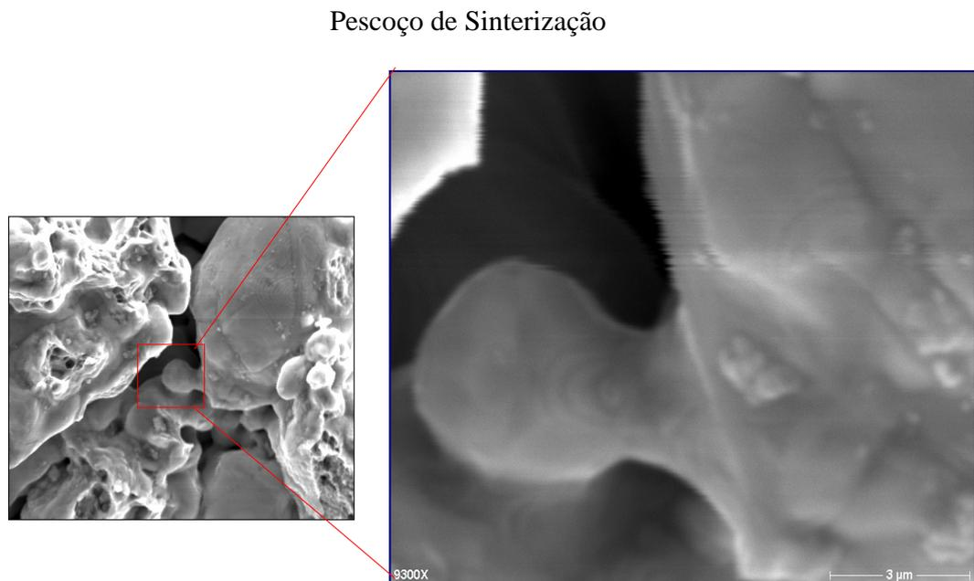
**Figura 4.13** – Micrografia eletrônica de varredura de uma fratura em um componente sinterizado [10]
