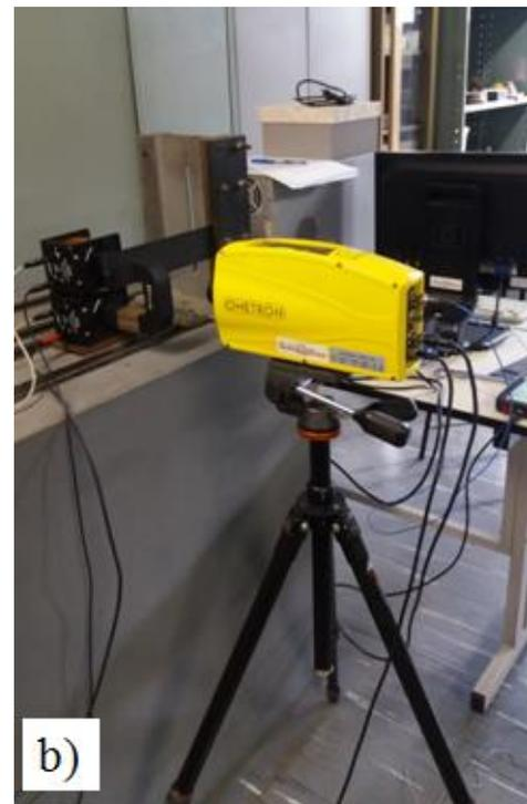
Figura 3.19 – a) Detalhe do posicionamento da viga sanduíche no entre-ferros do eletroímã. b) Incidência do laser sobre o corpo de prova.
