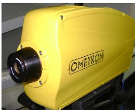
Fotografia B.15 – Vista frontal do vibrômetro laser.
