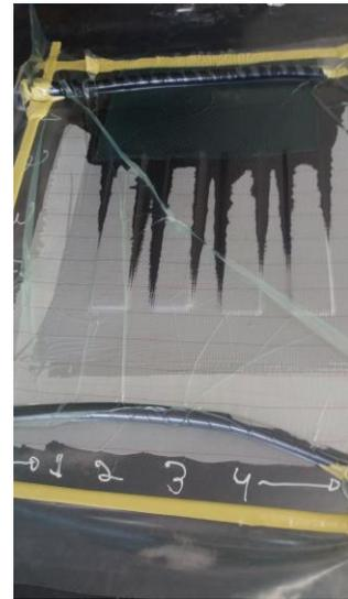
Figura 3.10 – Início do processo de infusão da resina sobre as lâminas.
