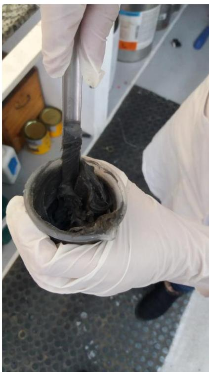
Figura 3.4 – Mistura manual do pó ferromagnético ao silicone.
