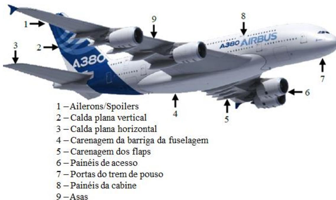
Figura 2.10 – Exemplos de aplicações de perfis sanduíche no A380. Fonte: Adaptado de Herrmann *et al.* (2005), *apud* Betts (2013).
