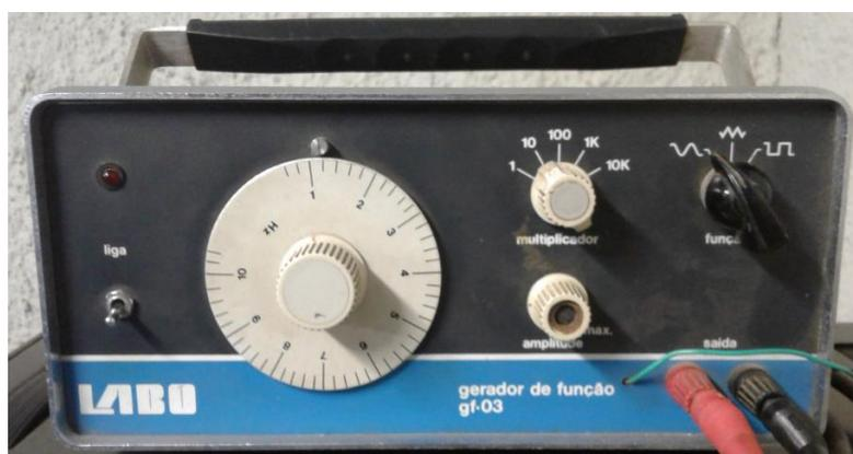
Fotografia B.7 – Gerador de função ou gerador de sinais.
