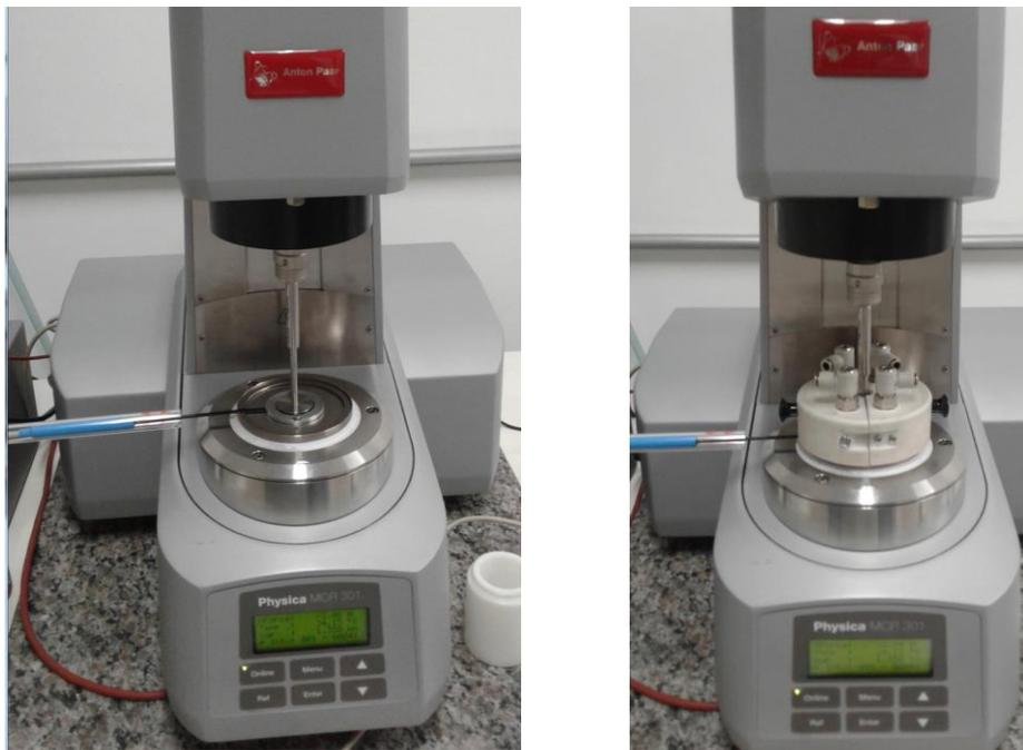
Figura 3.14 – Reômetro utilizado: à esquerda na ausência de campo magnético e à direita, com a cela magnética acoplada.
