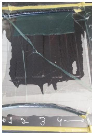
Figura 3.11 – Etapa final do processo de infusão da resina sobre as lâminas.
