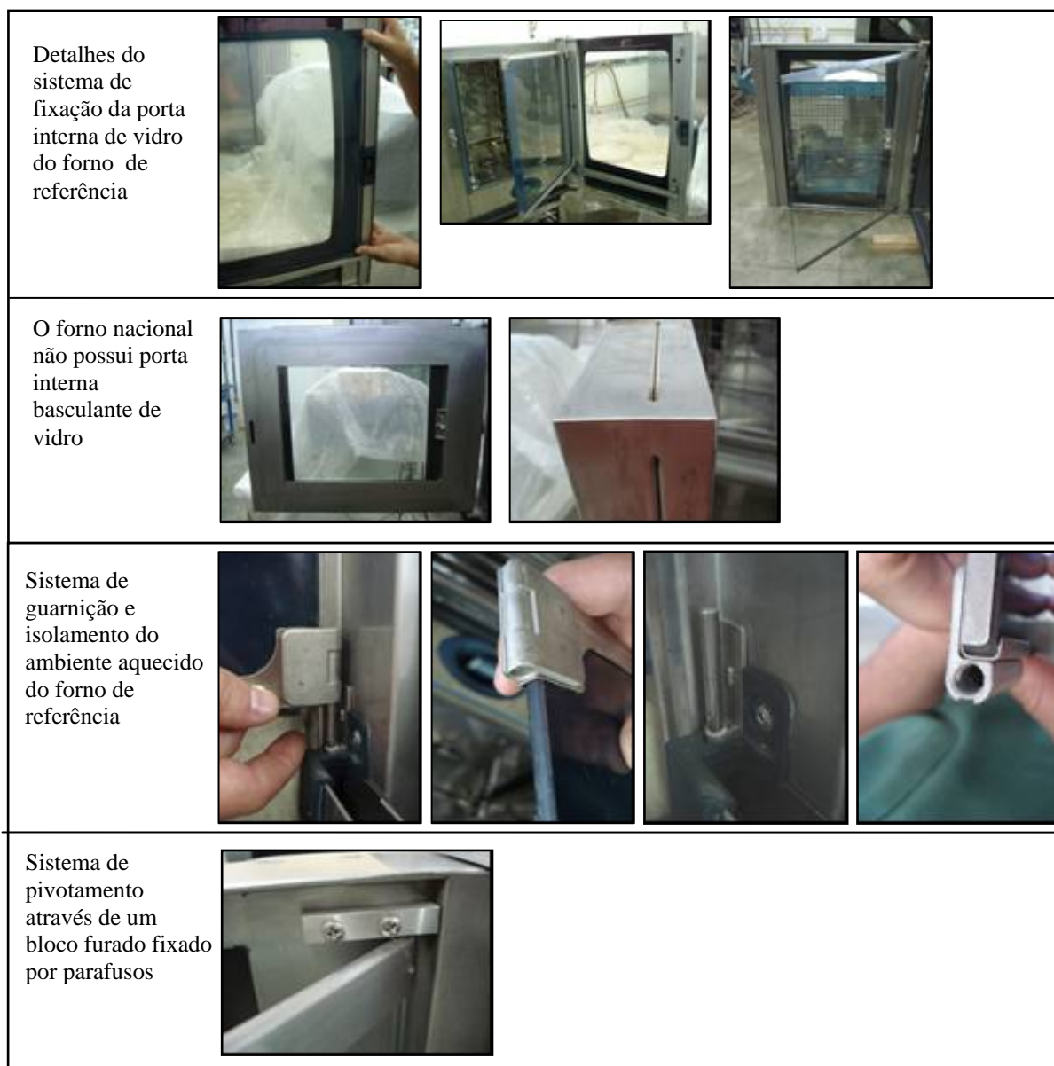
Figura 4.10 – Detalhes da porta interna de vidro
