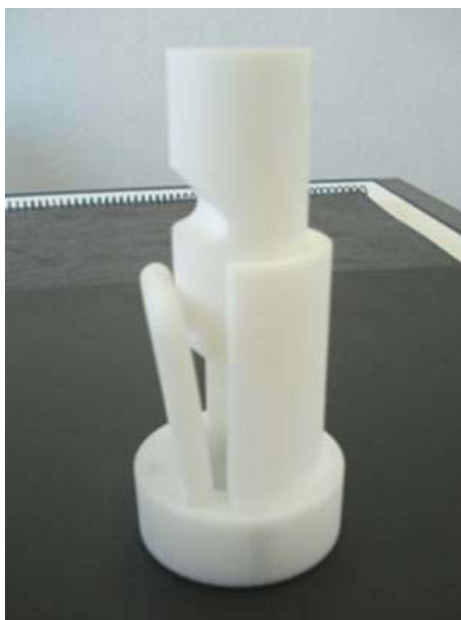
Figura 4.16 – Proposta de conceito em resina pelo processo de FDM
