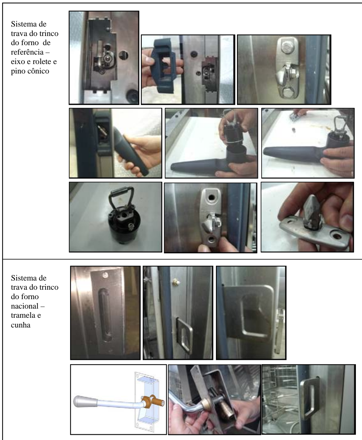
Figura 4.14 – Detalhes da trava da maçaneta dos dois fornos
