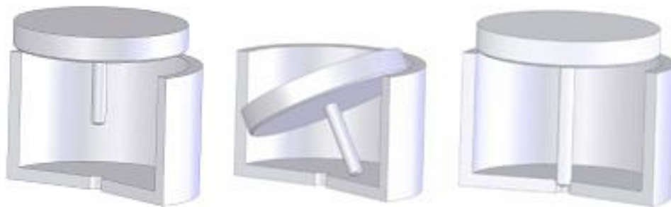
Figura 2.13 – Necessidade de pré-posicionamentos ao soltar o componente Fonte: Adaptado de Boothroyd, Dewhurst e Knight (1989)
