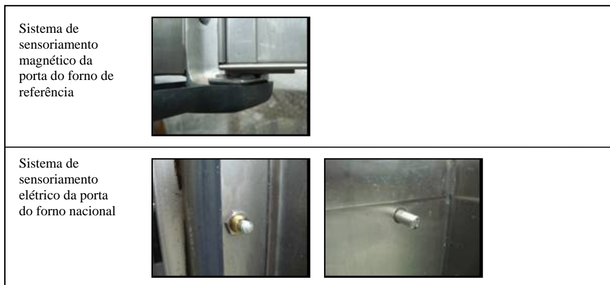
Figura 4.8 – Detalhes do sistema de sensoramento dos fornos
