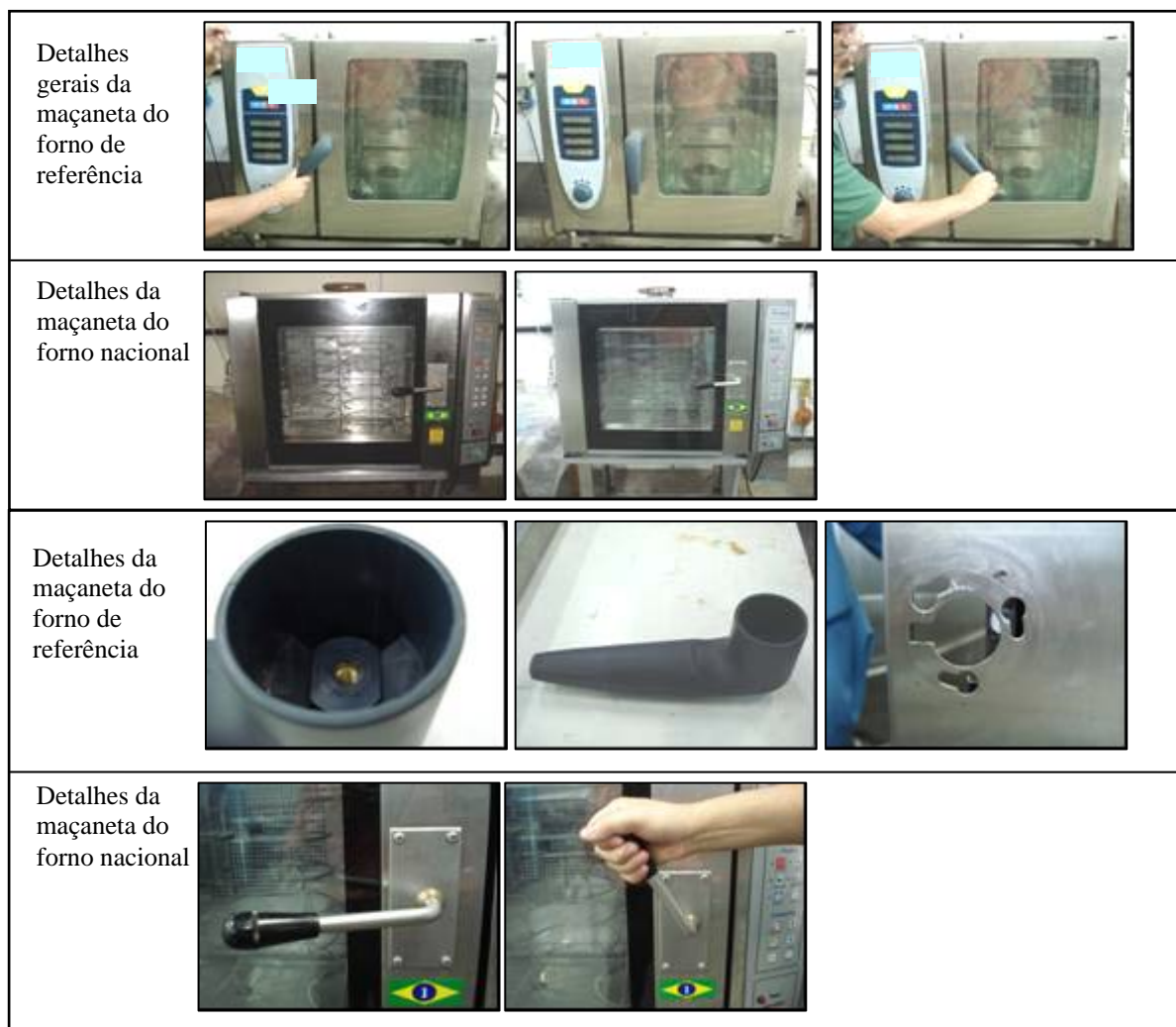
Figura 4.13 – Detalhes da maçaneta dos dois fornos
