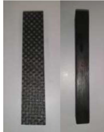
Figura 3.7: Bloco padrão para medição de velocidade de propagação do pulso ultrassônico.
