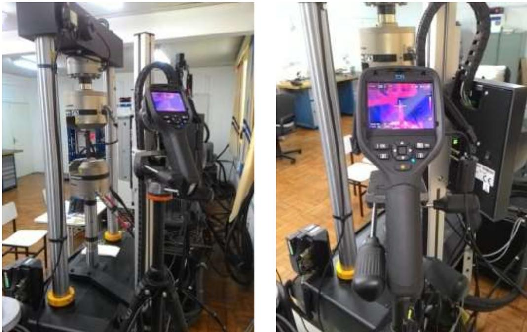
Figura 3.17: Registro da temperatura das amostras durante ensaios de fadiga.
