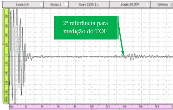
Figura 4.42: Onda  $L_{cr}$  para 100 mil ciclos de fadiga na amostra 2.
