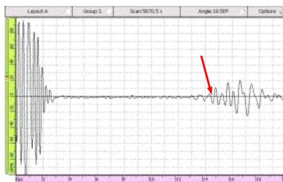
Figura 4.75: Onda  $L_{cr}$  para 20 mil ciclos de fadiga na amostra 4.
