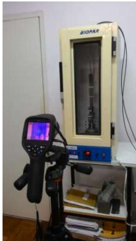
Figura 3.21: Câmera termográfica para medição de temperatura no interior da câmara de climatização.
