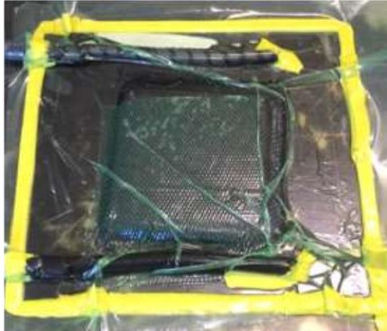
Figura 3.3: Resina infundida no interior da bolsa de vácuo.
