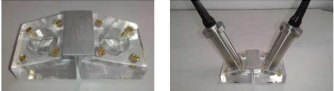
Figura 3.16: Sapata de acrílico para refração crítica da onda ultrassônica no laminado
