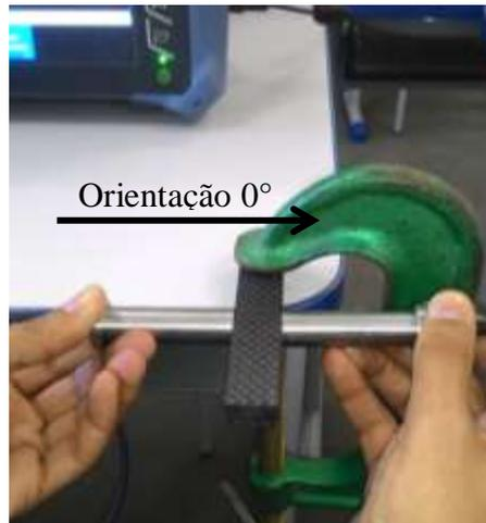
Figura 3.13: Posicionamento dos transdutores ultrassônicos no laminado  $(0, 90)_{40}$ .
