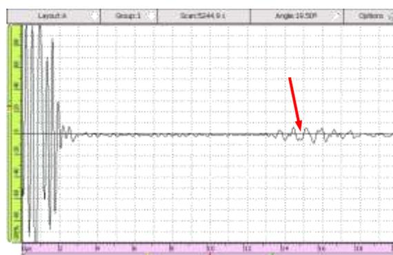
Figura 4.96: Onda  $L_{cr}$  para 100 mil ciclos de fadiga na amostra 5.
