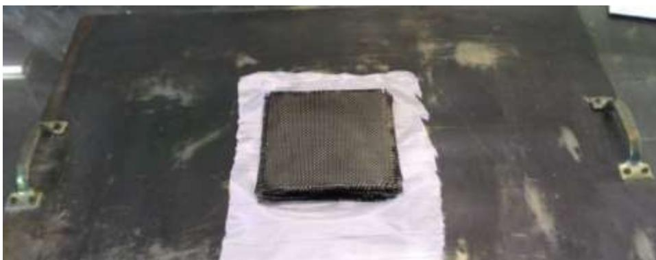
Figura 3.2: Fabricação do bloco padrão – camadas do tecido de carbono empilhadas.
