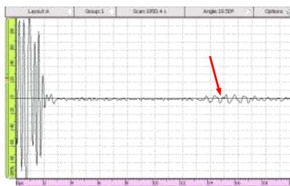
Figura 4.94: Onda  $L_{cr}$  para 80 mil ciclos de fadiga na amostra 5.
