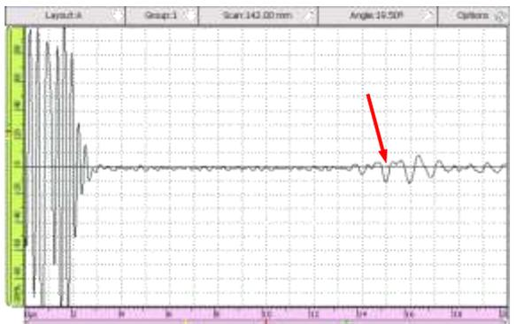
Figura 4.103: Onda  $L_{cr}$  para 40 mil ciclos de fadiga na amostra 6.
