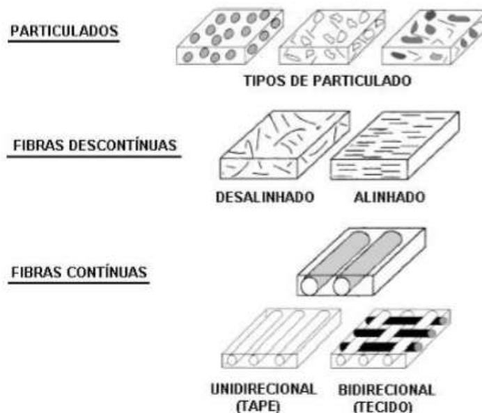
Figura 2.2: Tipos e formas de distribuição do reforço em compósitos
