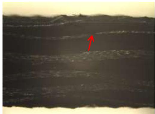
Figura 4.70: Imagem estereoscópica da seção longitudinal – amostra 3. Falha por tração de cabos do urdume.
