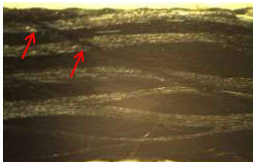
Figura 4.112: Imagem estereoscópica da seção longitudinal – amostra 6. Falha por tração de cabos do urdume.
