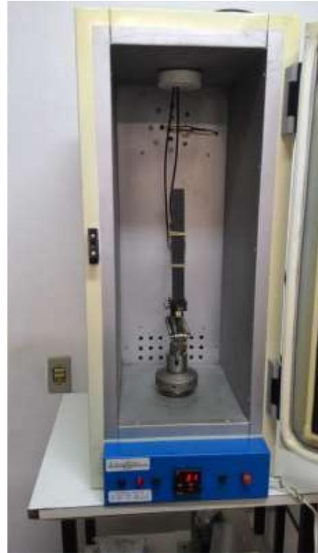
Figura 3.20b: Corpo de prova instrumentado no interior da câmara de climatização.
