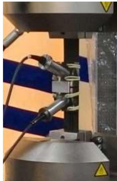
Figura 3.24: Posicionamento da sapata com os sensores na amostra.
