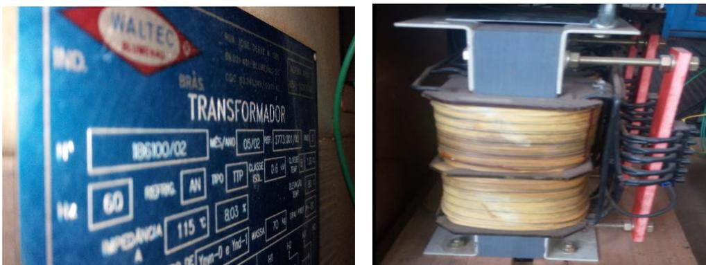
Figura 36: Transformador do lado do retificador
