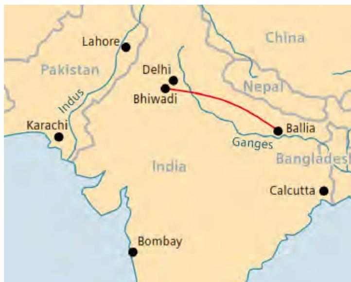
Figura 2: Ligação HVDC na Índia entre as estações de conversão de "Ballia" e "Bhiwadi", comprimento de 800 km.
