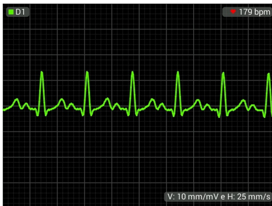
Figura 37 – Medição da derivação bipolar D2 de um sinal emulado na configuração taquicardia .
