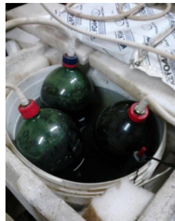
Figura 25: Biodigestor a) com substrato (esquerda); e b) biodigestores sob mesma temperatura.
