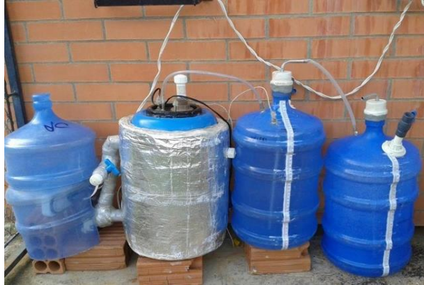
Figura 36: Aparato Biodigestor e Gasômetro - Experimento 2
