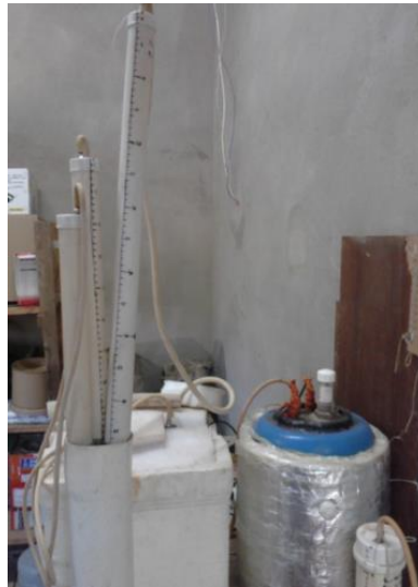
Figura 27: Gasômetros Tubulares 2,1(L) montados
