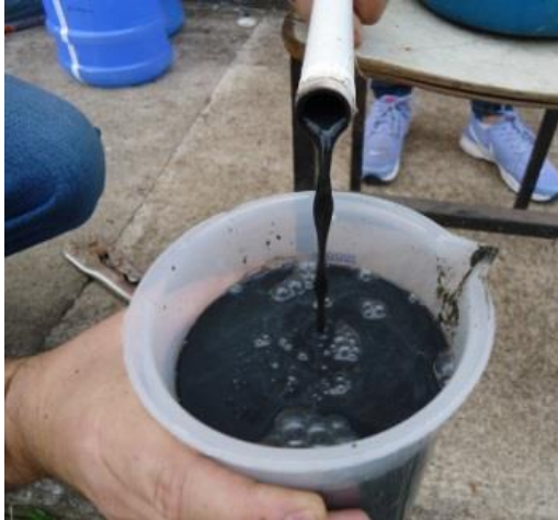
Figura 34: Retirada do efluente após TRH
