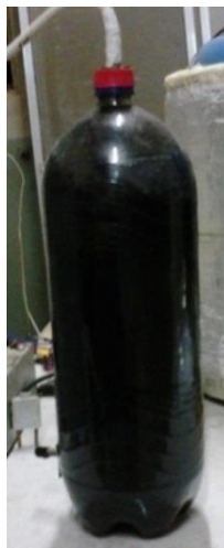
Figura 25: Biodigestor a) com substrato (esquerda); e b) biodigestores sob mesma temperatura.
