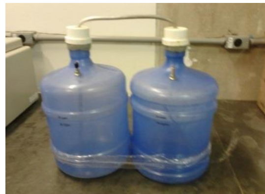
Figura 21: Gasômetro: a) montado vista lateral (esquerda) b) vista frontal (direita)
