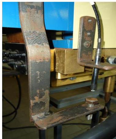
Figura 4.7 – Acoplamento do sensor do sistema de medição ao cabeçote móvel da máquina de soldagem. Fonte: A autora.
