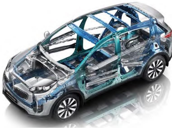
Figura 2.4 – Estrutura do Kia Sportage feita com 51% de AHSS. Fonte: WorldAutoSteel (2017).
