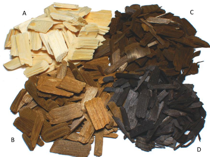
Figura 2.10: Lascas originais de madeira de pinho (A) e os correspondentes materiais torrefados. Marrom Claro (B) T=260 [°C]; t=25 min. Marrom Escuro (C) T=310 [°C]; t=8 min. Preto (D) T=310 [°C]; t=25 min.
