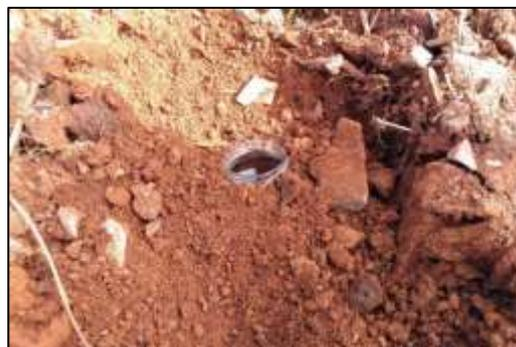
Figura 12 - Pote encaixado na abertura do solo na altura da superfície.
