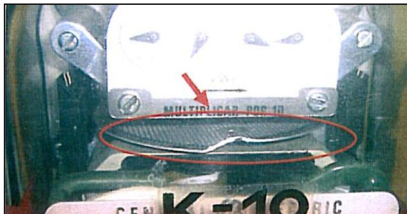
Figura 2.10: Fraude - Disco de medidor cortado. Fonte: (ROCHA, 2011).
