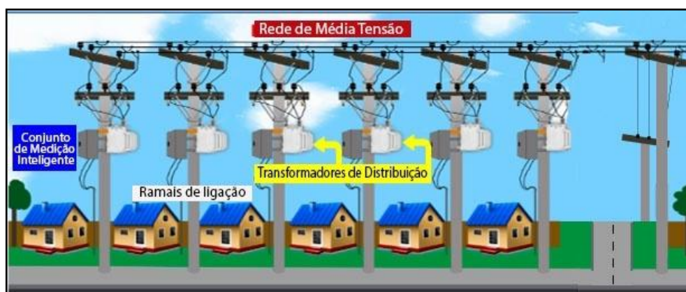
Figura 4.3: Desenho ilustrativo do sistema de distribuição aéreo sem rede de baixa tensão, acoplado aos conjuntos de medições inteligentes.
