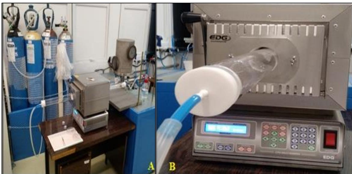
Figura 3.6 – (a) Sistema para o tratamento térmico dos filmes de  $Zn_{0,45}Cd_{0,55}O$ . (b) Parte frontal do forno para inserção do gás de interesse
