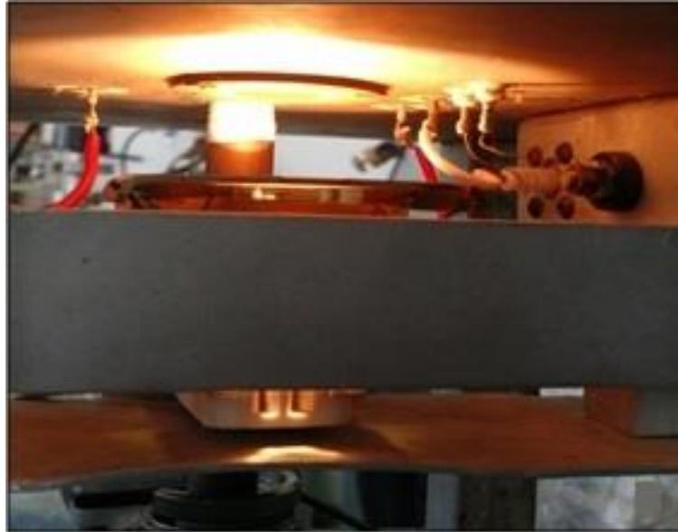
Figura 3.12 – Lâmpada com intensidade de emissão máxima na região do infravermelho
