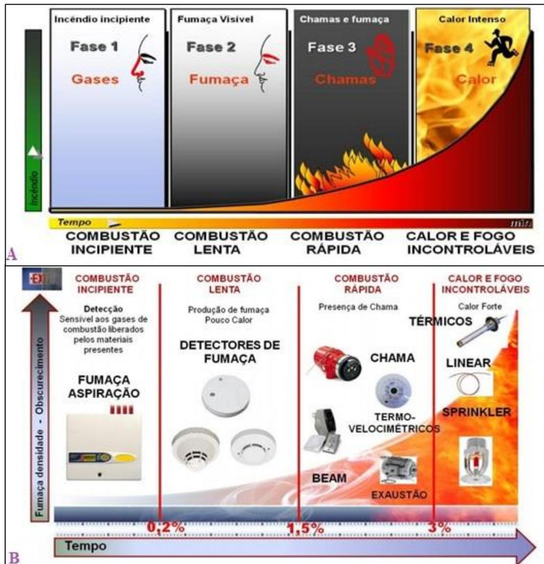
Figura 2.5 - (a) A curva do Fogo: fases do comportamento do incêndio com o passar do tempo. Fonte: Estudo ABINEE/Kidde. (b) Curva do Fogo x Detecção e Alarme de incêndios: concentração da fumaça proveniente de um incêndio ao longo do tempo e meios para detectá-las. Fonte: Estudo ABINEE/Kidde
