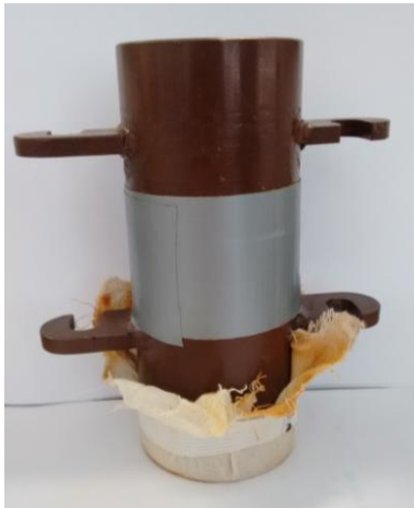
Figura 4.8 Corpo de prova durante a saturação
