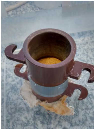
Figura 4.8 Corpo de prova durante a saturação
