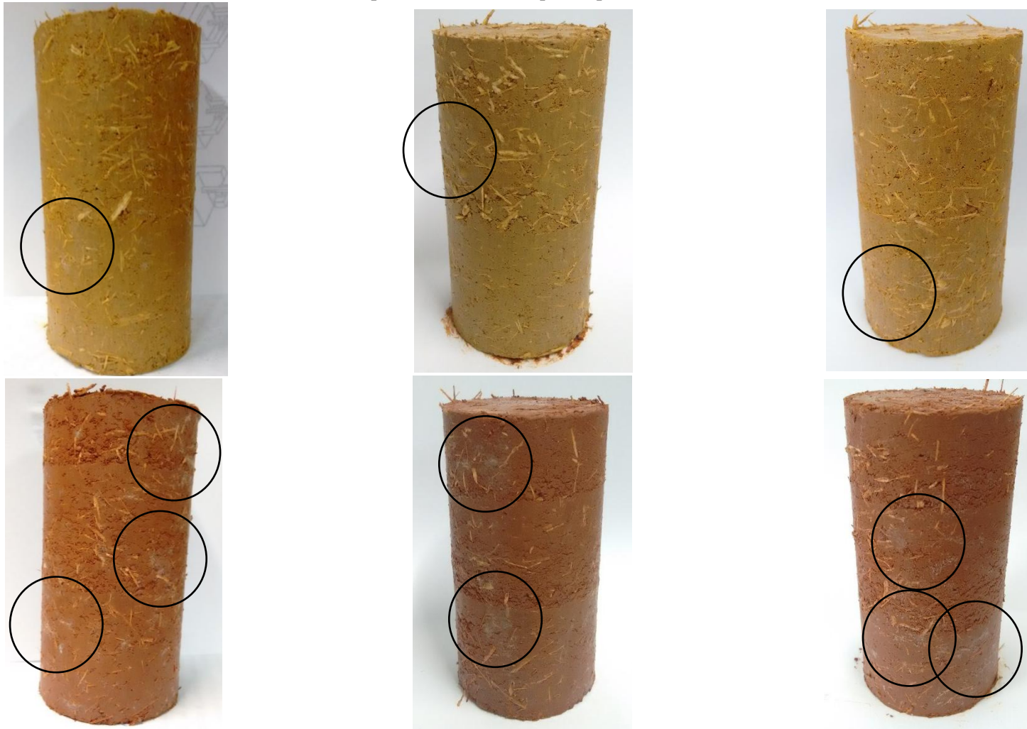
Figura 5.10 Corpos de prova de Argissolo Amarelo (acima) e Latossolo Vermelho (abaixo) com 1,5% de fibra armazenados por 2, 4 e 6 meses, respectivamente, da esquerda para direita.
