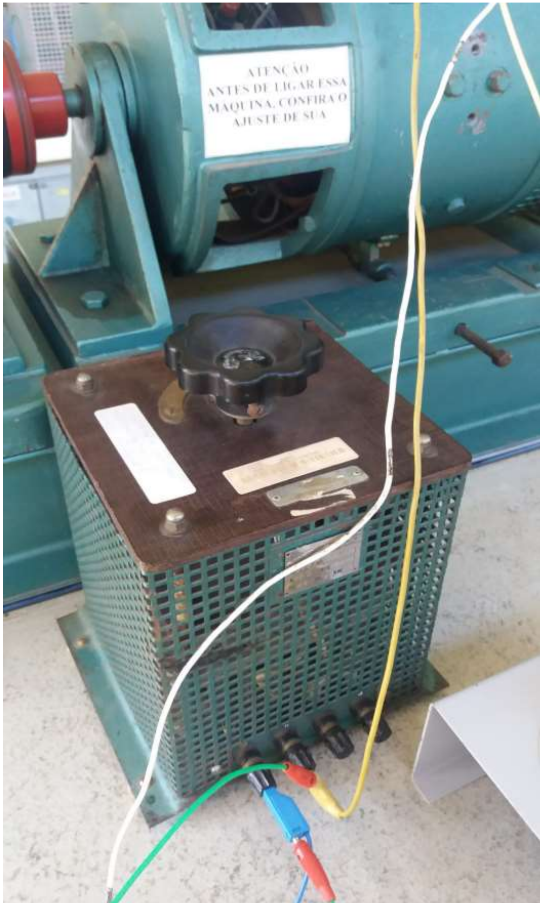
Foto 10: Reostato de partida do motor (reostato demarrador)
