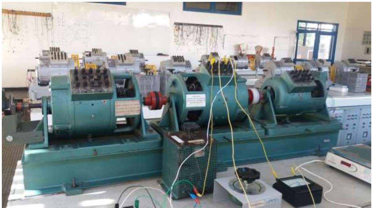
Foto 2: Máquina de corrente contínua a ser frenada – máquina central
