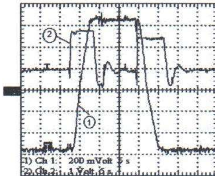
Figura 38: Ilustração da frenagem regenerativa mostrando a velocidade na curva 1 e corrente da máquina na curva 2, para corrente de frenagem de 7,77[A].
