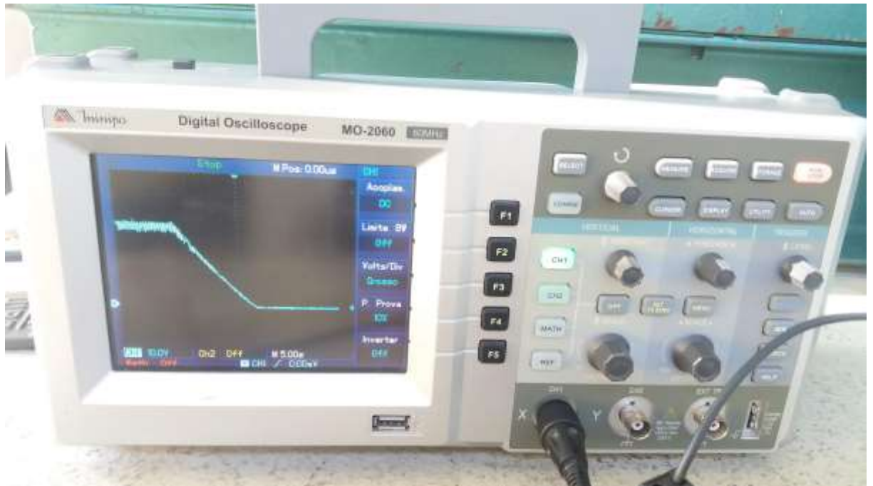
Foto 11: Registro desde a velocidade inicial (1800 rpm), até a parada da MCC (0 rpm).
