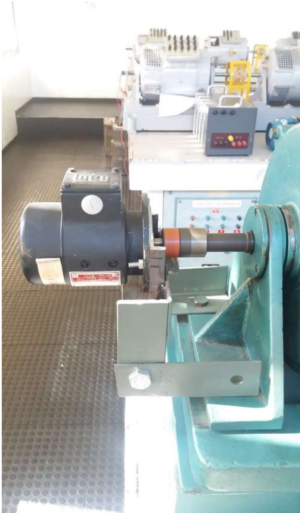
Foto 9: Vista do tacogerador (transdutor de velocidade) para registro da velocidade
