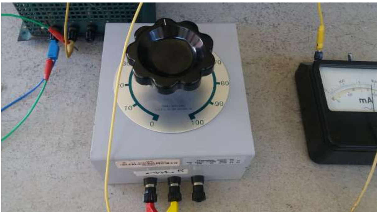
Foto 4: Reostato de campo da máquina de corrente contínua (MCC)
