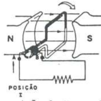
Figura 6: Bobina na posição I. U_{AB} = 0 .
