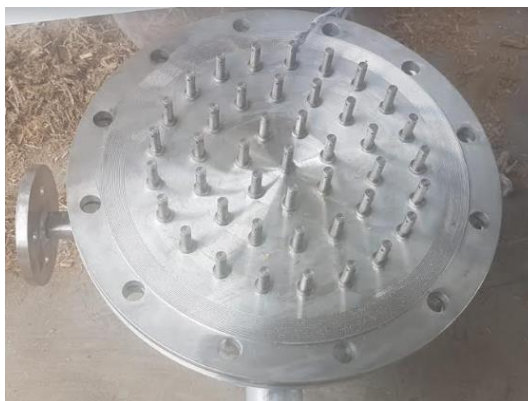
Figura 46 – Placa de distribuição de bicos injetores construída
