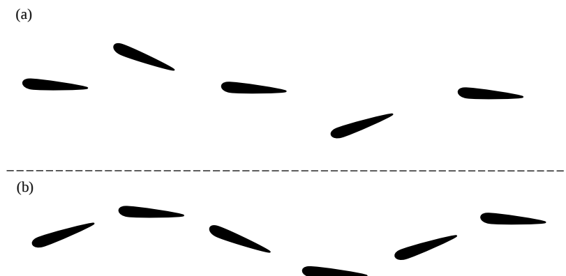
Figura 5.16- Torção e flexão em fase ( 0^\circ - (a)) e fora de fase ( 90^\circ - (b)).
