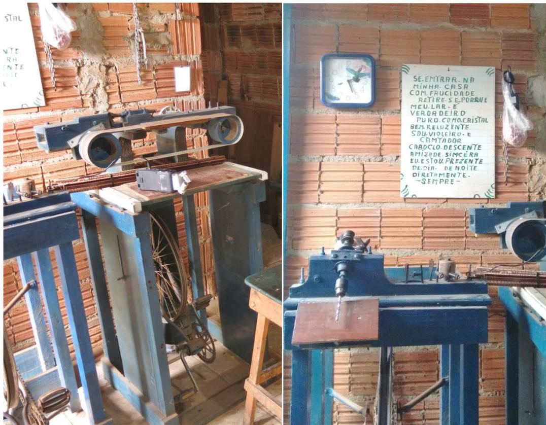
Figura 6 - Máquinas feitas pelo Índio Cachoeira com engrenagens de bicicletas.
