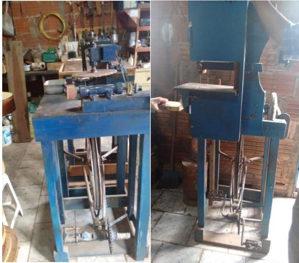
Figura 5 – Máquinas feitas pelo Índio Cachoeira com engrenagens de bicicletas.
