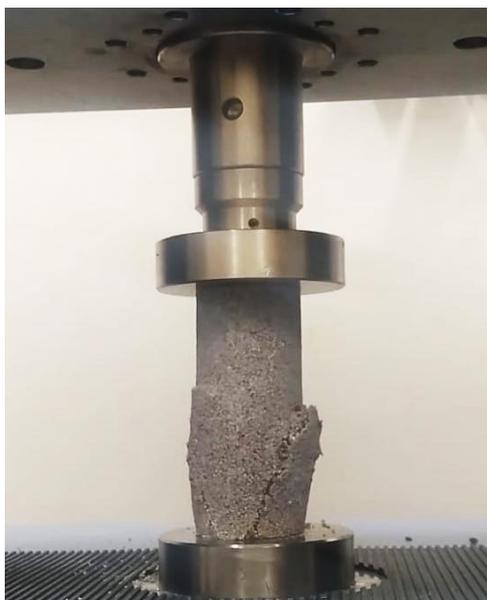
Figura 4.4: Corpo de prova Cilíndrico no Ensaio de Compressão
