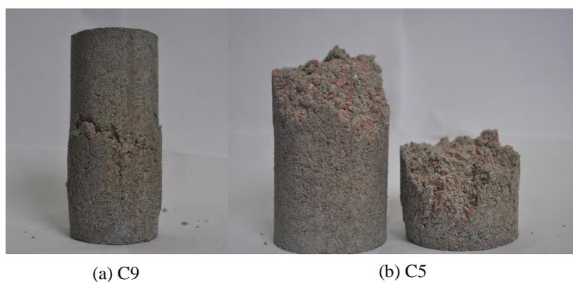
Figura 4.6: Fratura dos Corpos de Prova Cilíndricos (a) C9, (b) C5
