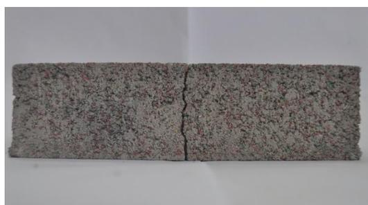
Figura 4.9: Fratura dos Corpos de Prova Prismáticos, C2
