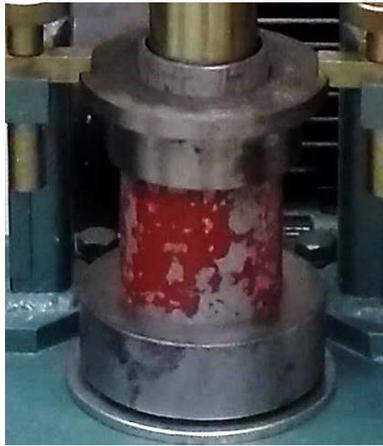
Figura 3.6: Molde Cilíndrico
