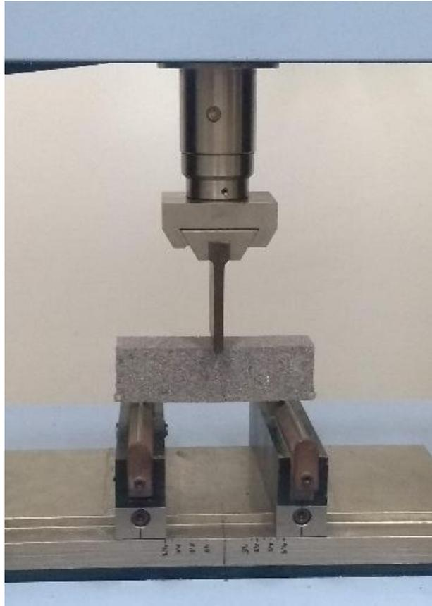
Figura 3.4: Ensaio de flexão em três pontos
