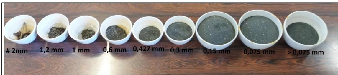
**Figura 11** - Separação granulométrica do rejeito da mineração de Ferro
