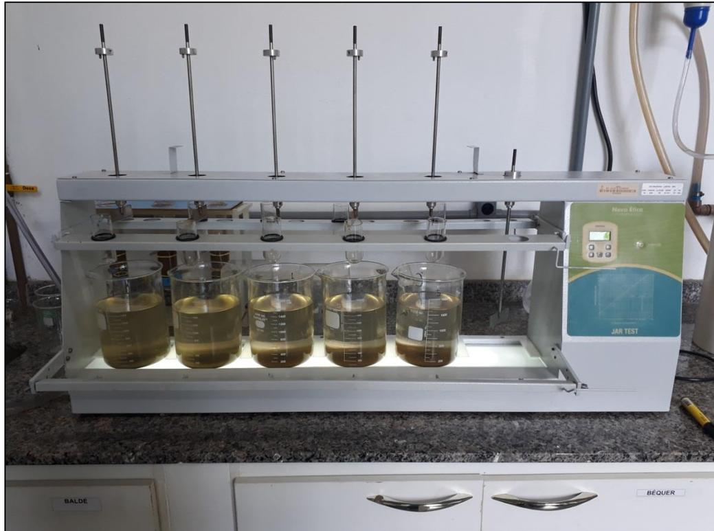
**Figura 8** - *Jar Test* utilizado no experimento
