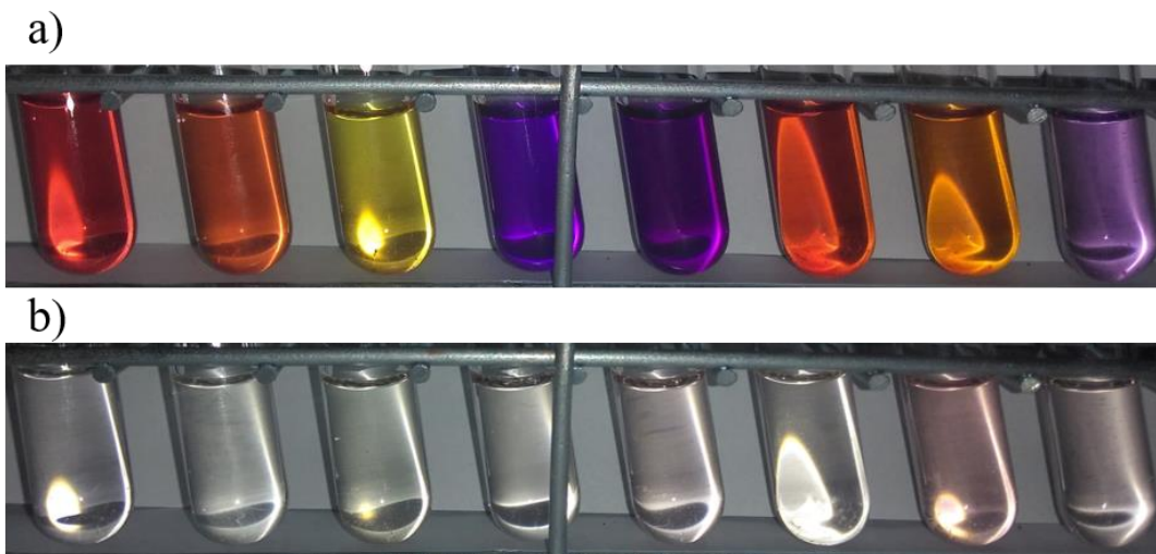
Figura 3.30: Estudo solvatocrômico para o complexo CoMC a) após ser solubilizado e b) após as soluções serem irradiadas com luz na região do visível. Solventes da esquerda para a direita: MeOH, EtOH, IPA, DMSO, DMF, Ace, MEK e THF.
