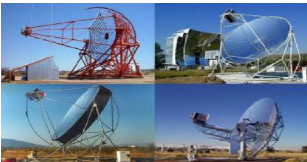
Figura 14 - Exemplos de coletores parabólicos
