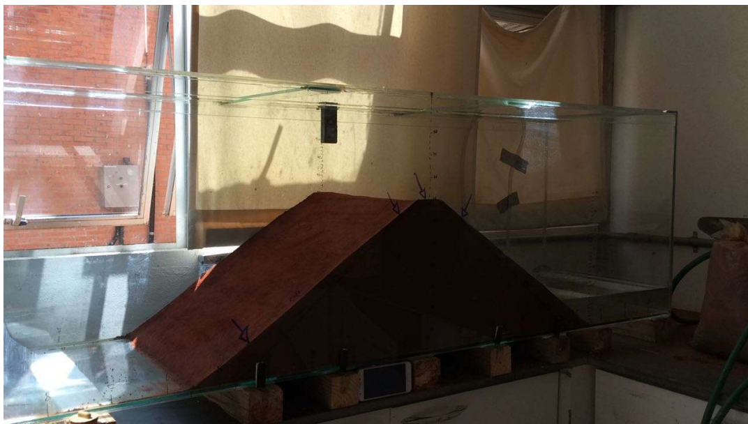
Figura 49 – Início do enchimento do reservatório. Fonte: Próprio autor
