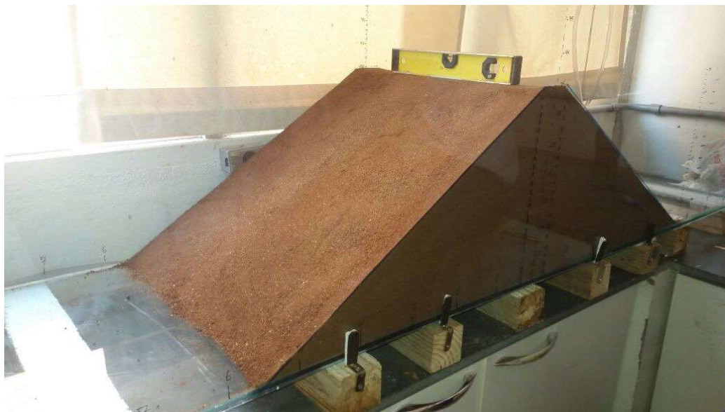
Figura 29 – Nivelamento do modelo. Fonte: Próprio autor
