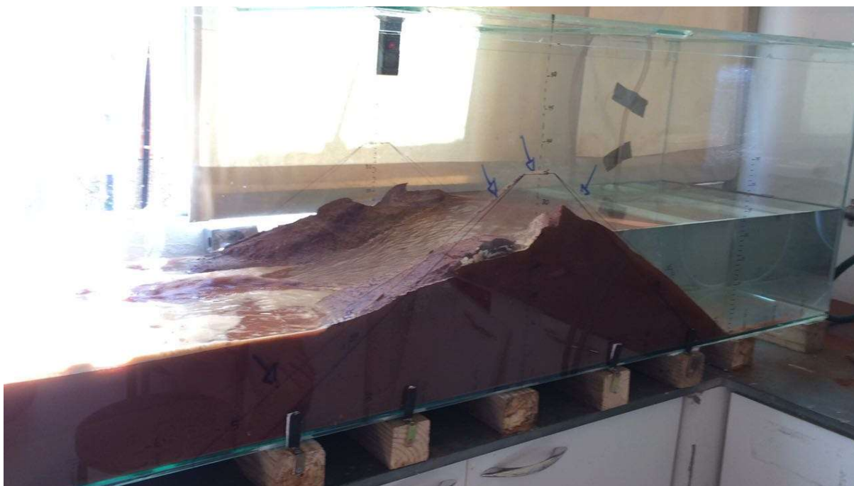
Figura 53 – Colapso estrutural do modelo reduzido de barragem. Fonte: Próprio autor
