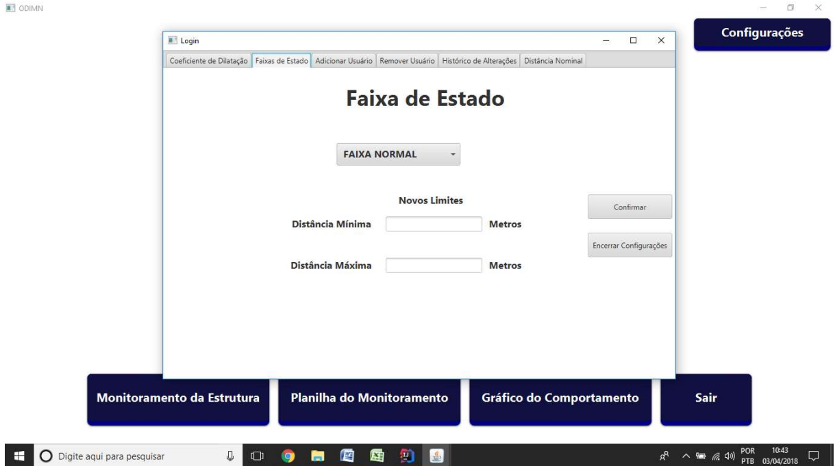
Figura 35 – Tela de configuração dos limites de faixas para interpretação do sistema. Fonte: Próprio autor
