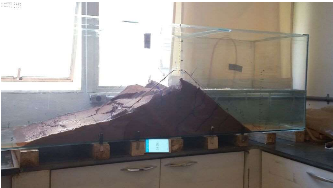
Figura 47 – Colapso estrutural do modelo reduzido de barragem. Fonte: Próprio autor
