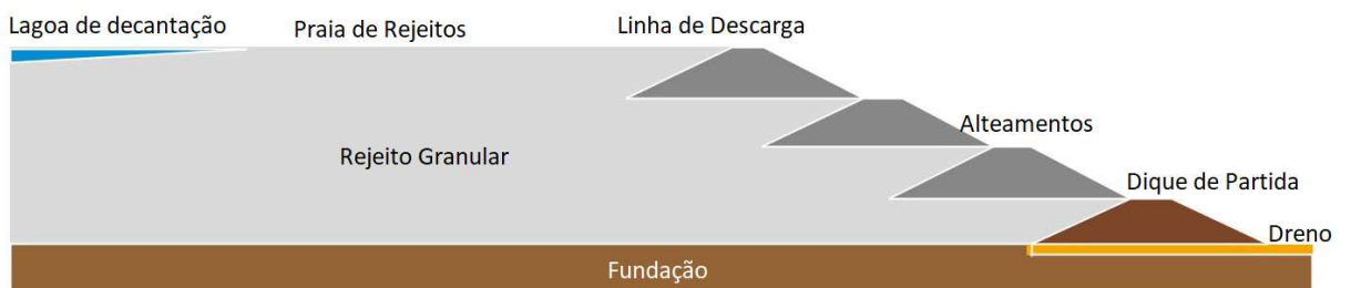
Figura 7 – Método de alteamento a montante de barragem de rejeito de mineração. Fonte: IBRAM (2016)
