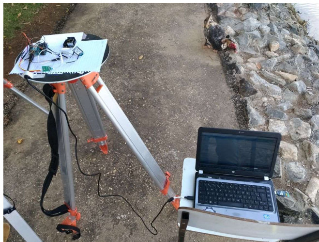
Figura 57 – Conexão dos componentes eletrônicos do sistema proposto com o computador. Fonte: Próprio autor
