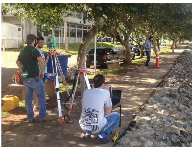
Figura 56 – Ensaio de comparação das leituras da estação total com o sistema proposto. Fonte: Próprio autor
