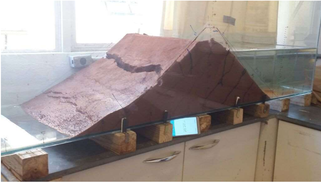
Figura 46 – Início da ruptura no modelo reduzido de barragem. Fonte: Próprio autor
