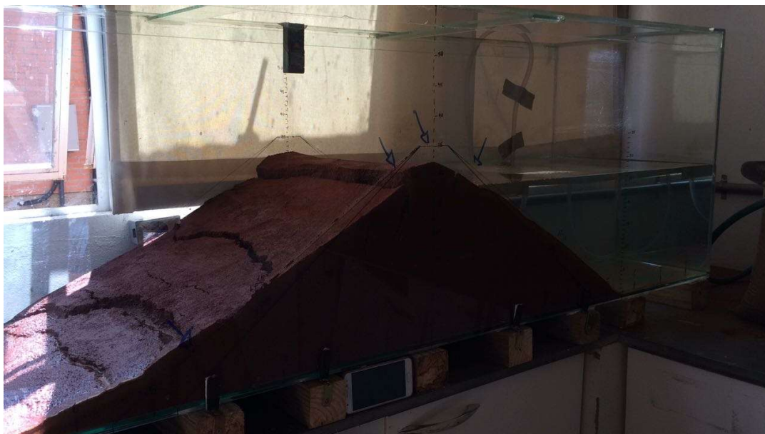
Figura 52 – Início da ruptura no modelo reduzido de barragem. Fonte: Próprio autor
