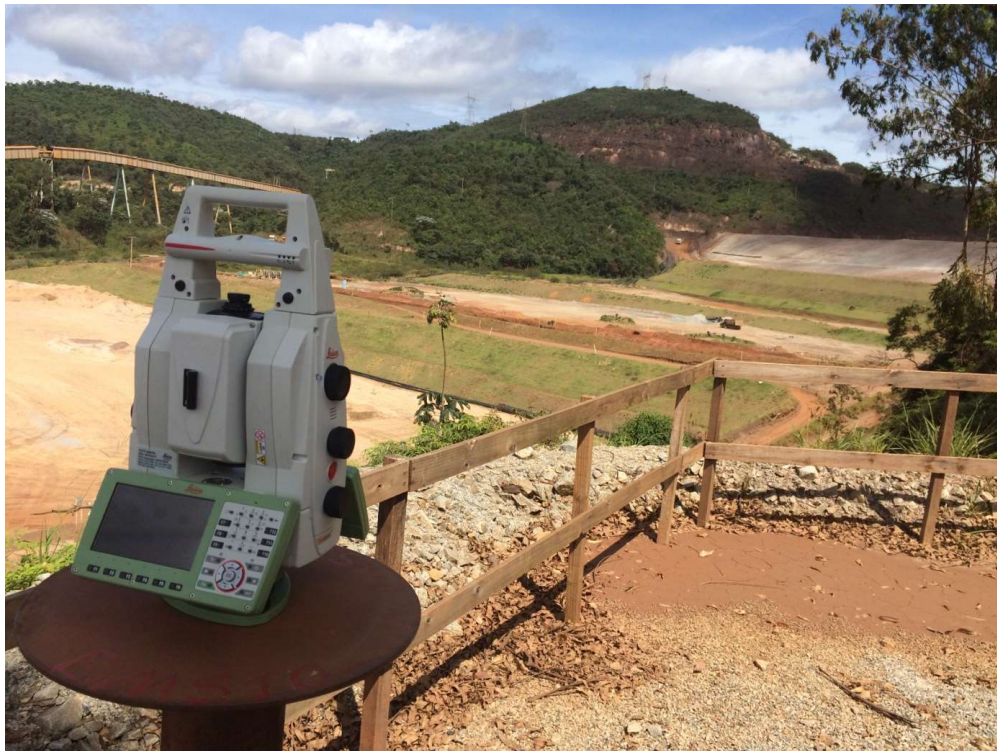
Figura 20 – Estação total robótica realizando monitoramento de campanha na barragem Sela na mineradora Samarco. Fonte: Próprio autor
