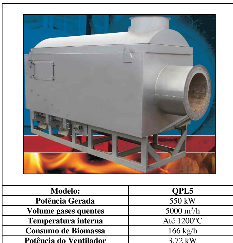
Figura 3.6. Fornalha de combustão pirolítica[77].
