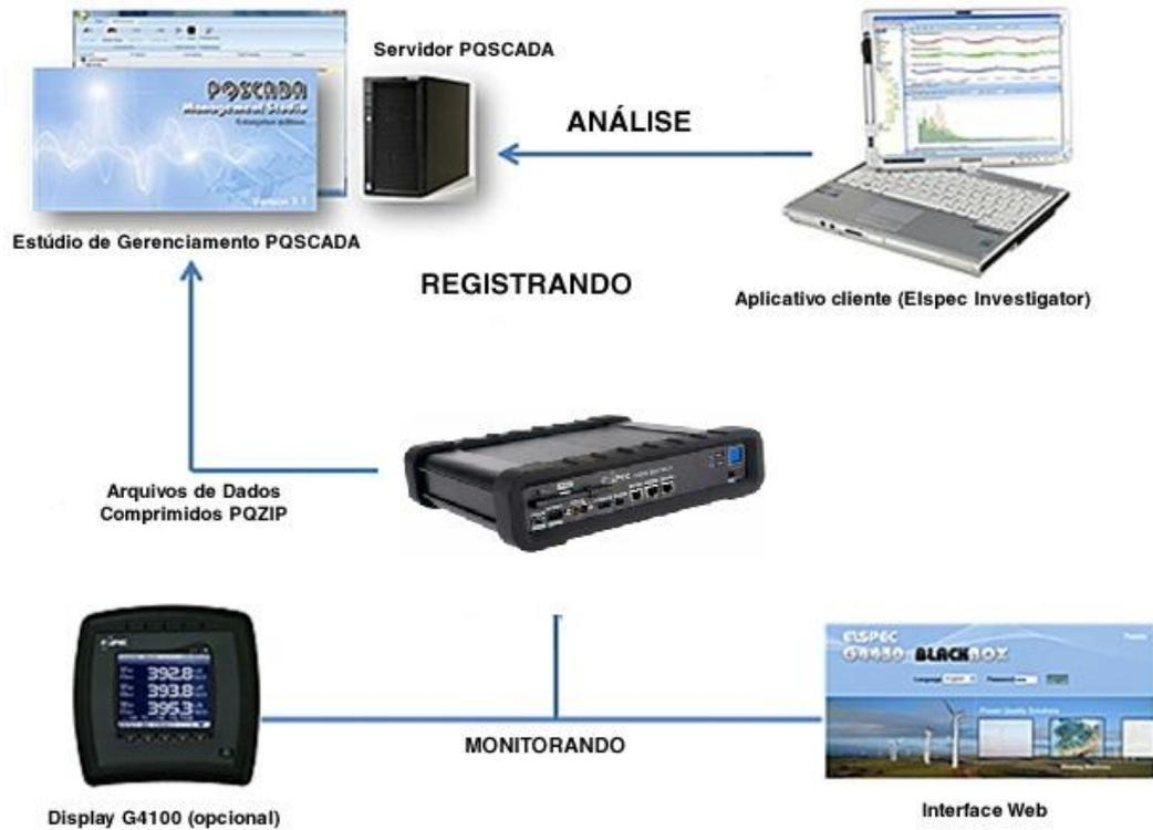
Figura 34: Visão geral da estrutura de dados do G4500 BLACKBOX
