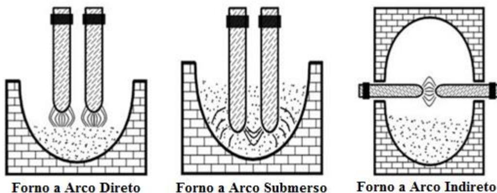
Figura 2: Tipos de fornos a arco elétricos
