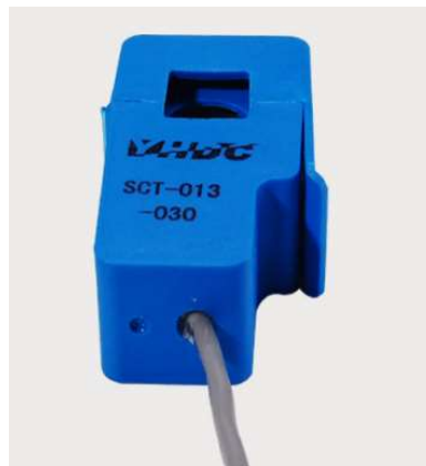
Figura 6.17 – Transformador de corrente utilizado no sensor proposto, modelo SCT-013, fabricado pela YHDC®.
