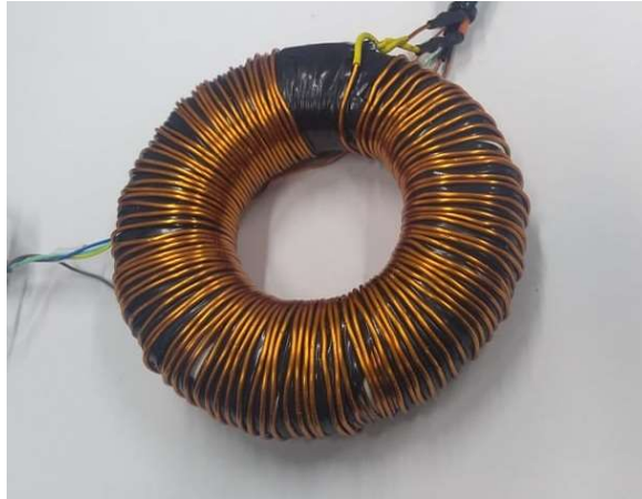
Figura 6.6 – Núcleo acoplado aos enrolamentos primário, auxiliar e de saída.
