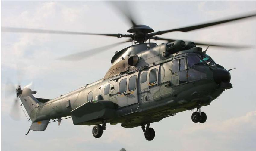
Figura 4 – Modelo de Aeronave H225m, classificado como pesado.
