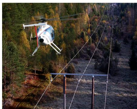
(a) Inspeção com helicóptero (NEWAIR, 2019).
