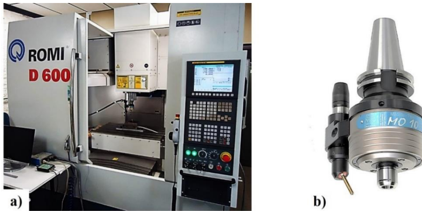
Figura 22. a) Centro de usinagem ROMI ® D 600 (Fonte: autoria própria); b) Cabeçote multiplicador de rotação OMG ® MO10.ER16.MAS403.BT40 (adaptado de < http://www.omgamerica.com/usa-drilling-systems/mo-r19/mo10-us >, acesso em 14 de novembro de 2017).
