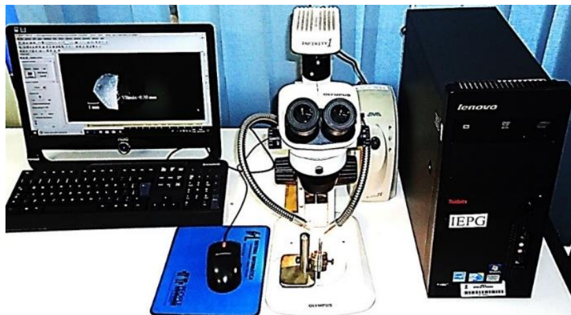
Figura 31. Configuração utilizada no monitoramento do desgaste das ferramentas de corte (Fonte: autoria própria).
