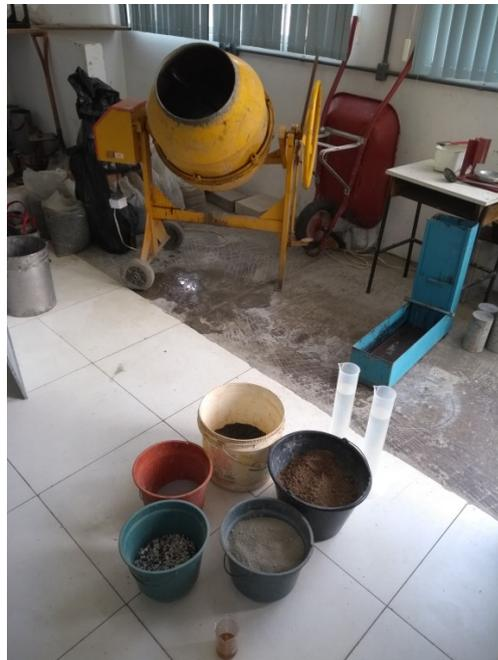
Figura 28: Materiais separados para produção do CAA com 10% substituição de brita por resíduo polimérico em massa (Fonte: PRÓPRIO AUTOR, 2020).
