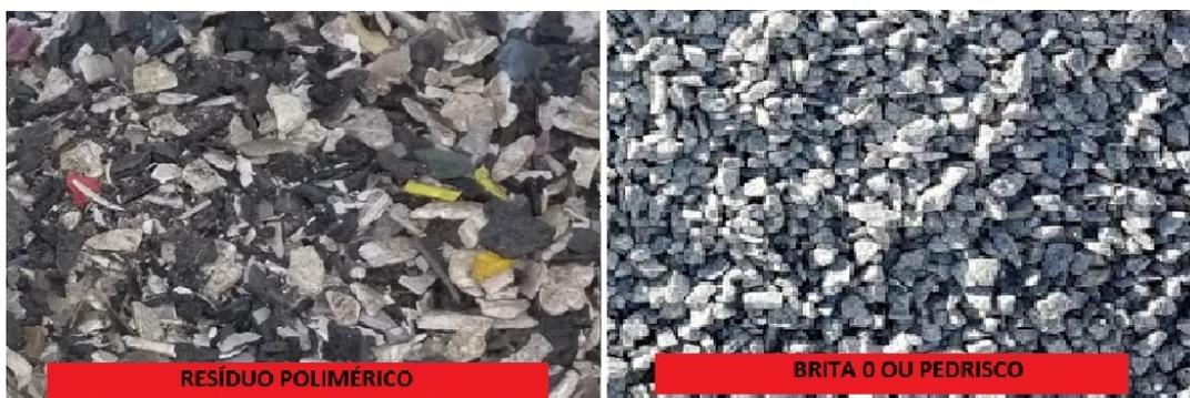
Figura 41: comparação visual entre o resíduo polimérico e a brita, utilizados nesta pesquisa como agregado graúdo (Fonte: PRÓPRIO AUTOR, 2020).
