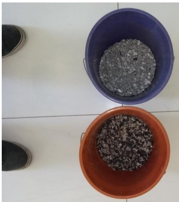
Figura 27: Resíduo polimérico oriundo da reciclagem de refrigeradores separados segundo granulometria graúda e miúda (Fonte: PRÓPRIO AUTOR, 2019).
