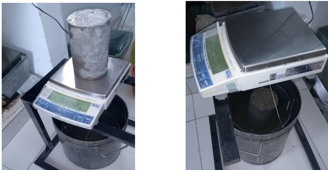
Figura 30: Ensaio de massa específica em corpo de prova de concreto (Fonte: PRÓPRIO AUTOR, 2020).
