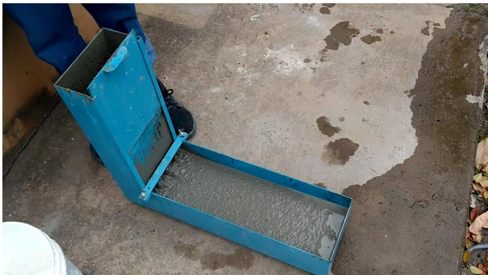
Figura 55: Ensaio de habilidade passante caixa L do CAA com substituição de RP por brita (Fonte: PRÓPRIO AUTOR, 2020).
