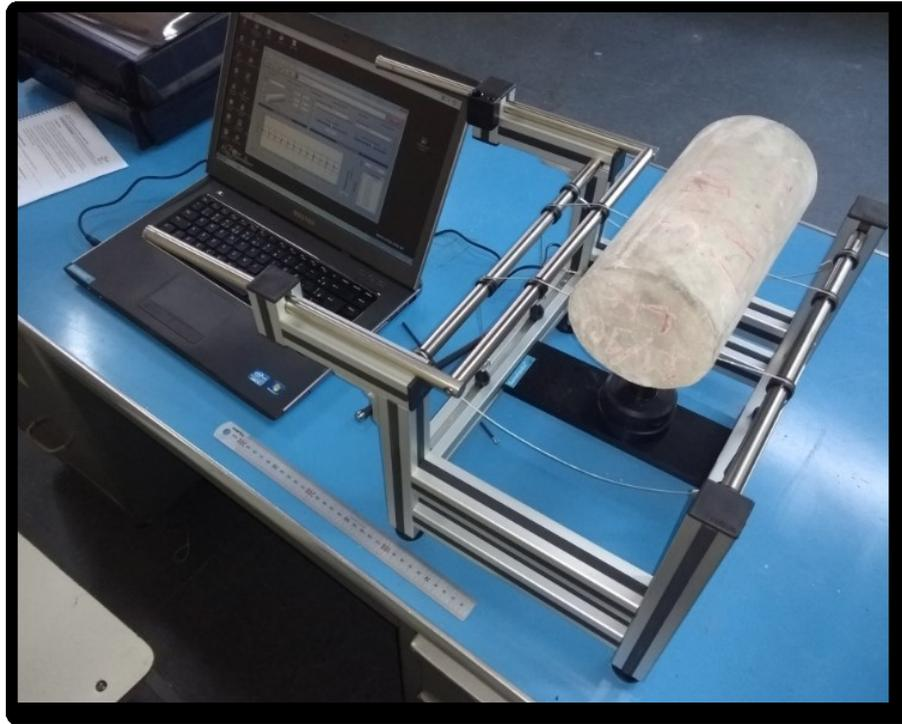
Figura 31: Configuração básica do software Sonelastic para a caracterização dos corpos de prova e suporte para realização do ensaio (Fonte: PRÓPRIO AUTOR, 2020).
