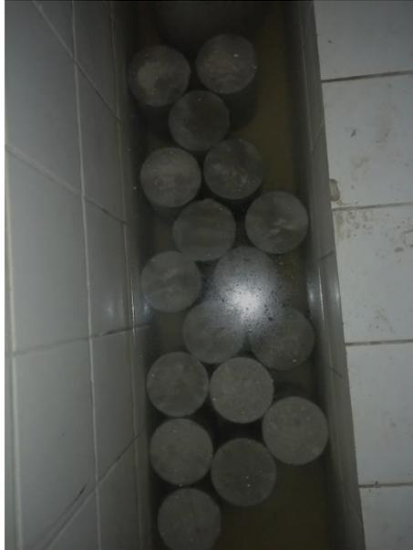
Figura 29: Corpos de prova 10 x20 mm de CAA desmoldados submersos em processo de cura (Fonte: PRÓPRIO AUTOR, 2020).
