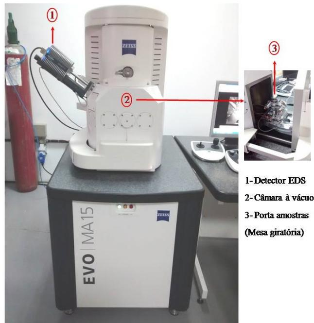
Figura 33: Microscópio eletrônico de varredura (MEV) utilizado para análise das amostra - marca Zeiss, modelo EVO MA15, Lab. de Física-Química UNIFEI/Itajubá (Fonte: PRÓPRIO AUTOR, 2020).
