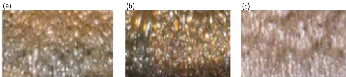
Figura 2.19 – Aspectos da espuma na flotação de minério de ferro nas etapas (a) rougher , (b) cleaner ; (c) scavenger .
