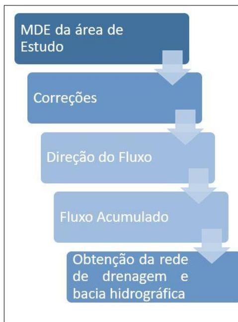
Figura 10 - Principais etapas realizadas para geração da rede de drenagem e microbacias hidrográficas.
