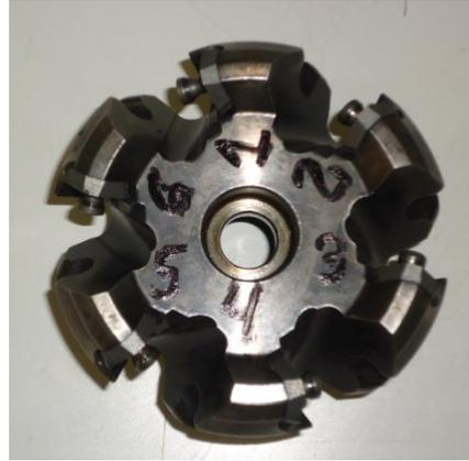
Figura 3.10- Identificação na parte frontal da fresa da posição das pastilhas.
