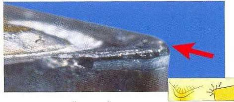
Figura 2.33 - Deformação plástica da aresta de corte (SANDVIK COROMANT, 1999)
