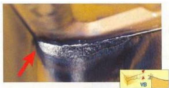
Figura 2.25- Desgaste de flanco (SANDVIK COROMANT, 1999)
