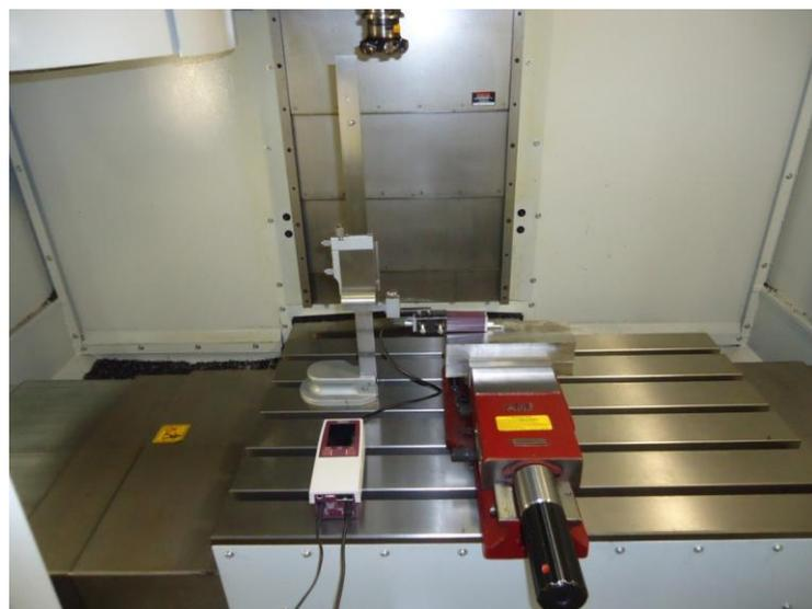
Figura 3.11- Sistema de medição das rugosidades  $R_a$  e  $R_t$ .
