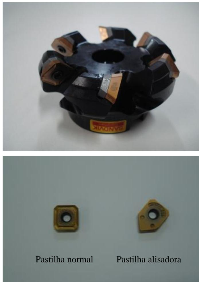
Figura 3.4- Fresa de facear e pastilhas utilizadas (Sandvik Coromant, 2011).
